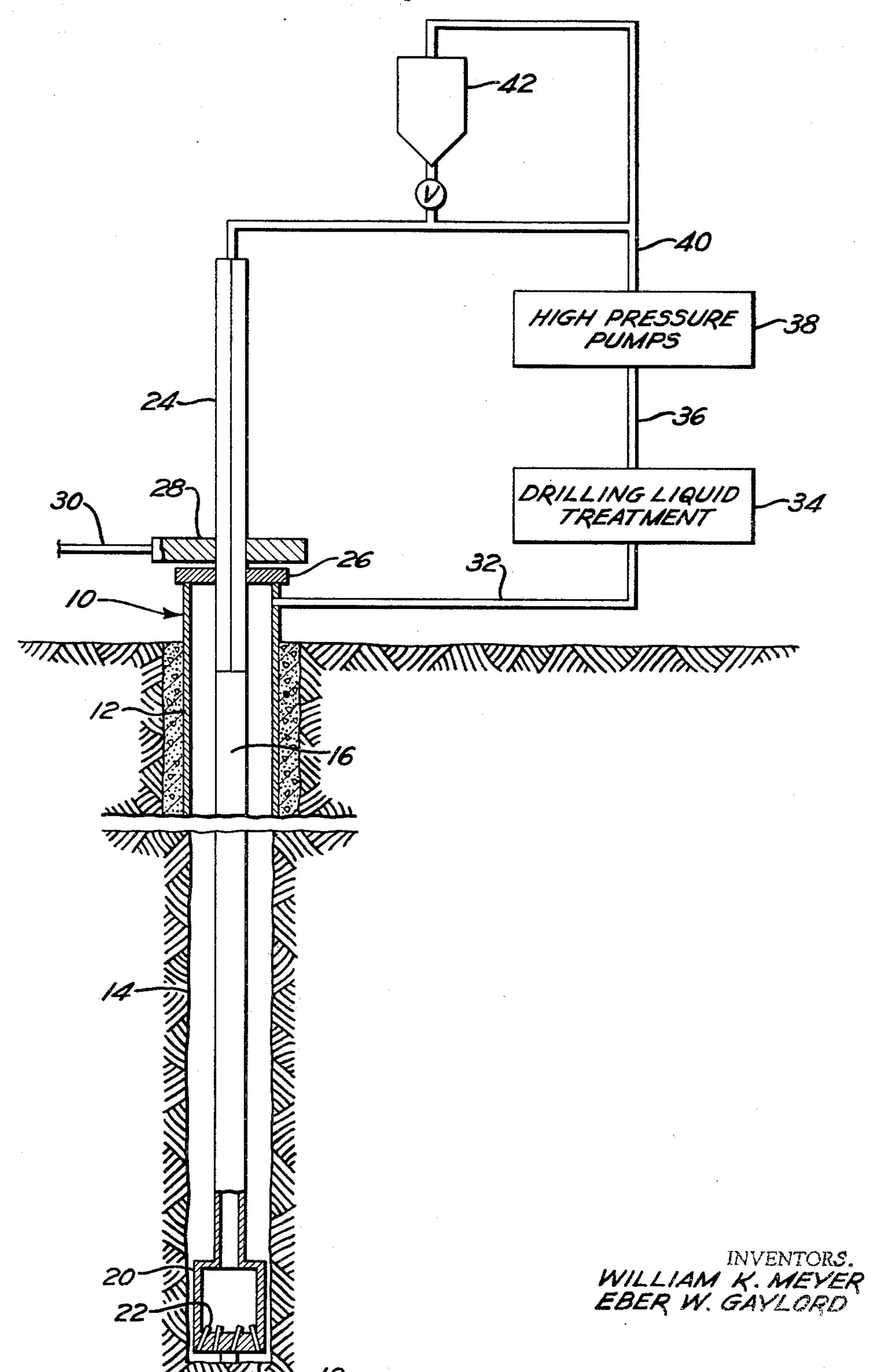
3,508,621 ABRASIVE JET DRILLING FLUID
