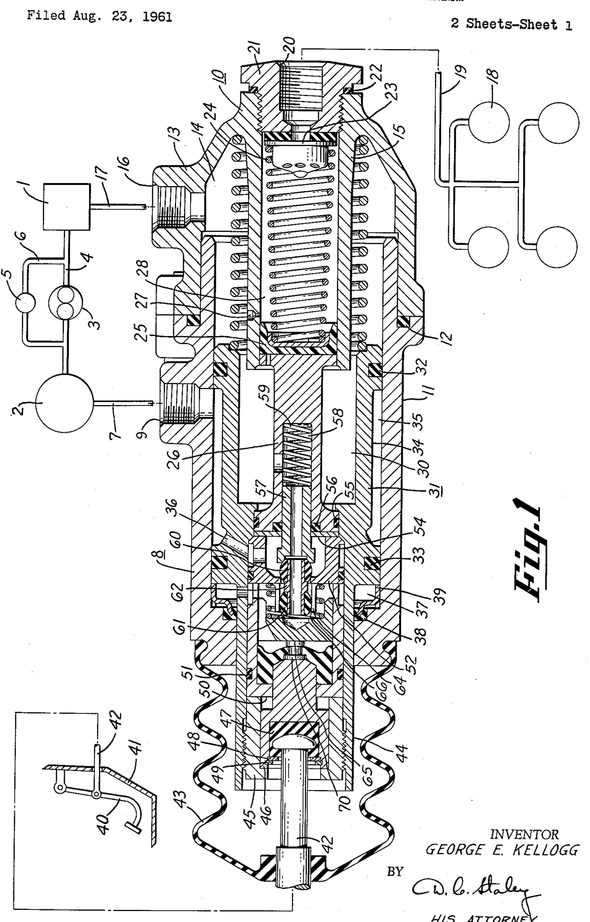
BRAKE BOOSTER CONTROL VALVE MECHANISM
