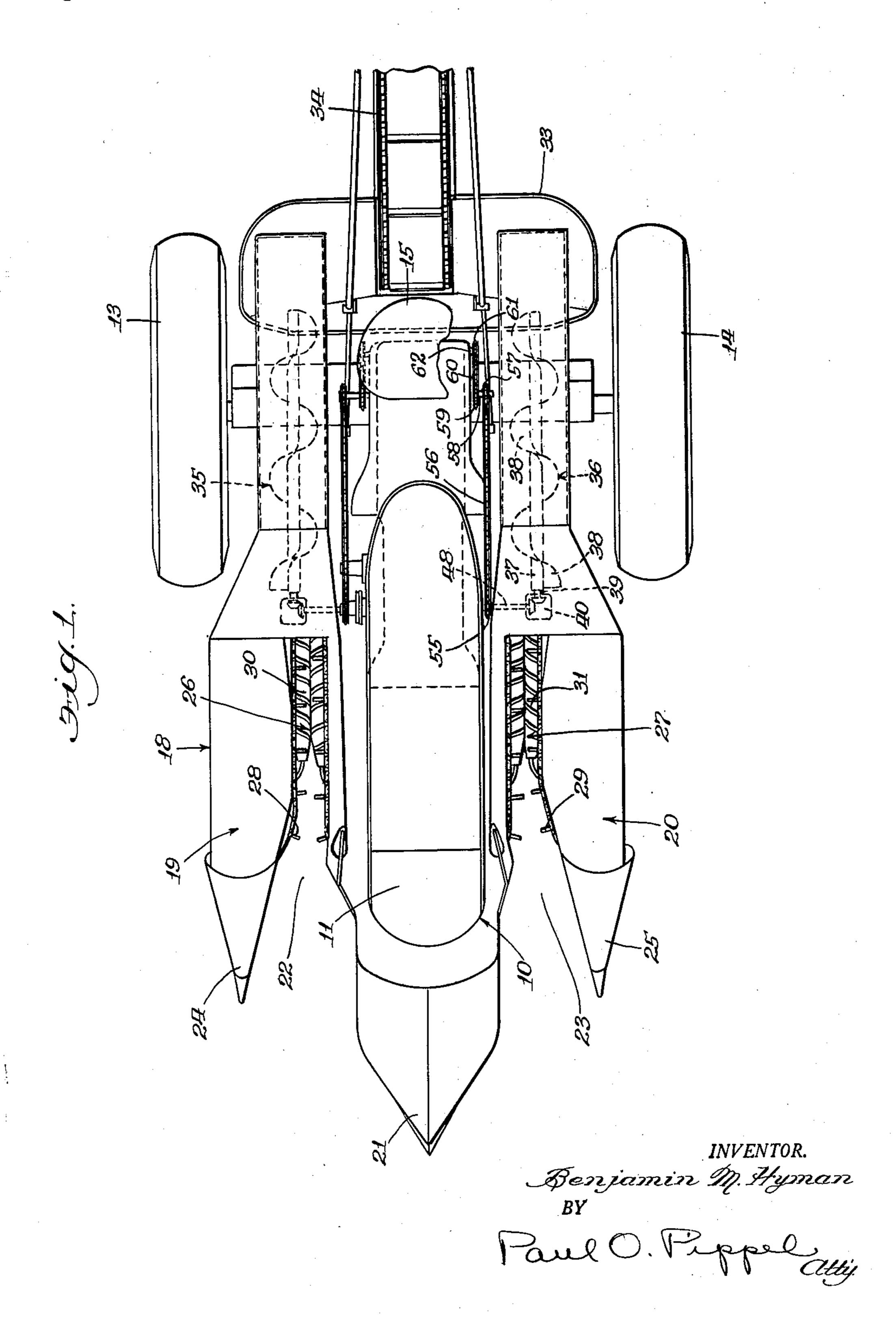
OPEN END AUGER FEED OVER INCLINED ROLLS
