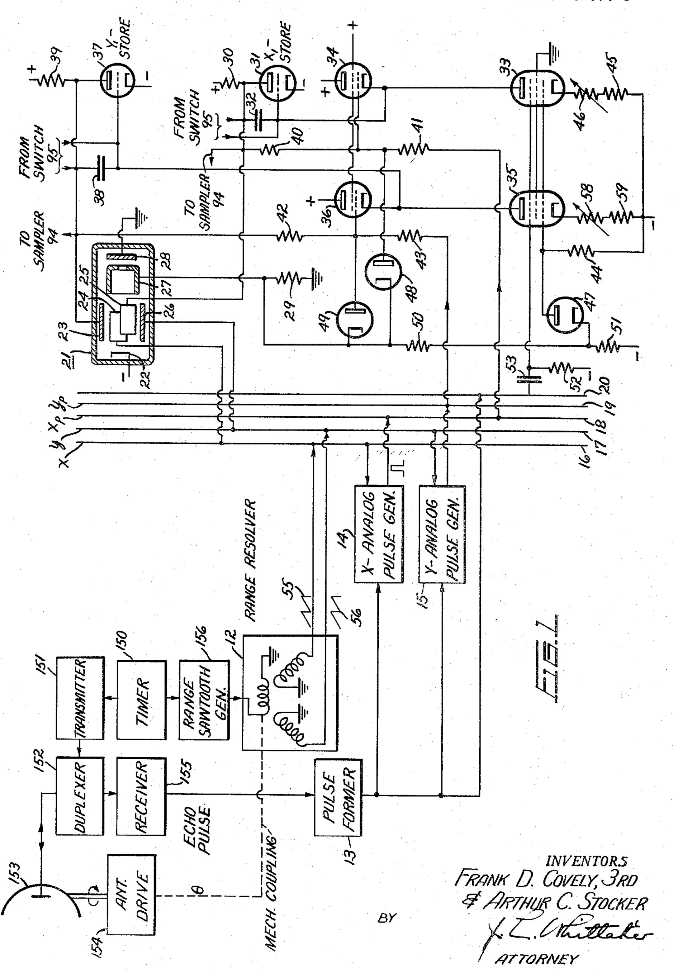
AUTOMATIC CORRECTION CIRCUIT FOR STORED ELECTRICAL DATA
