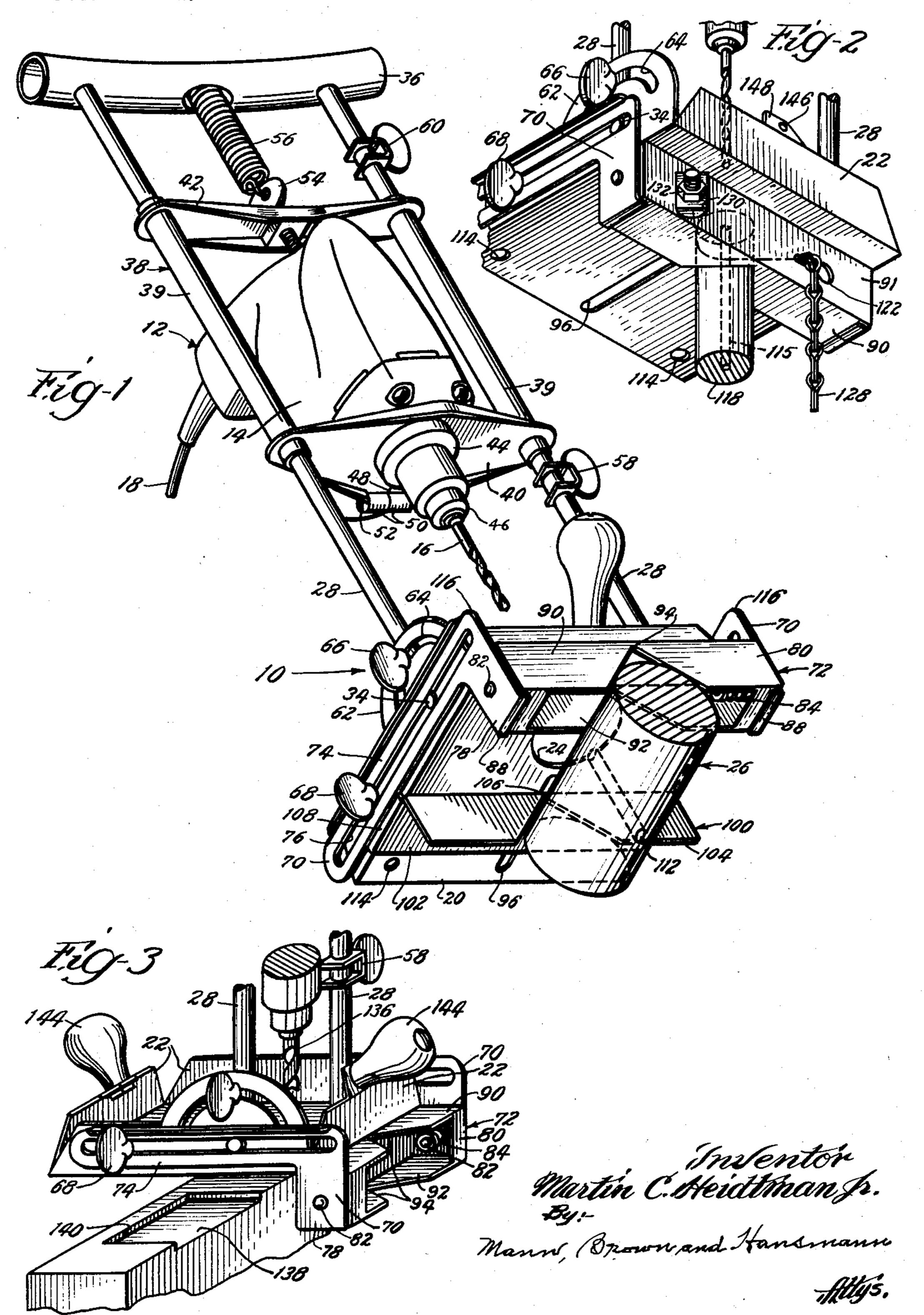
PORTABLE FRAME FOR POWER HAND DRILLS
