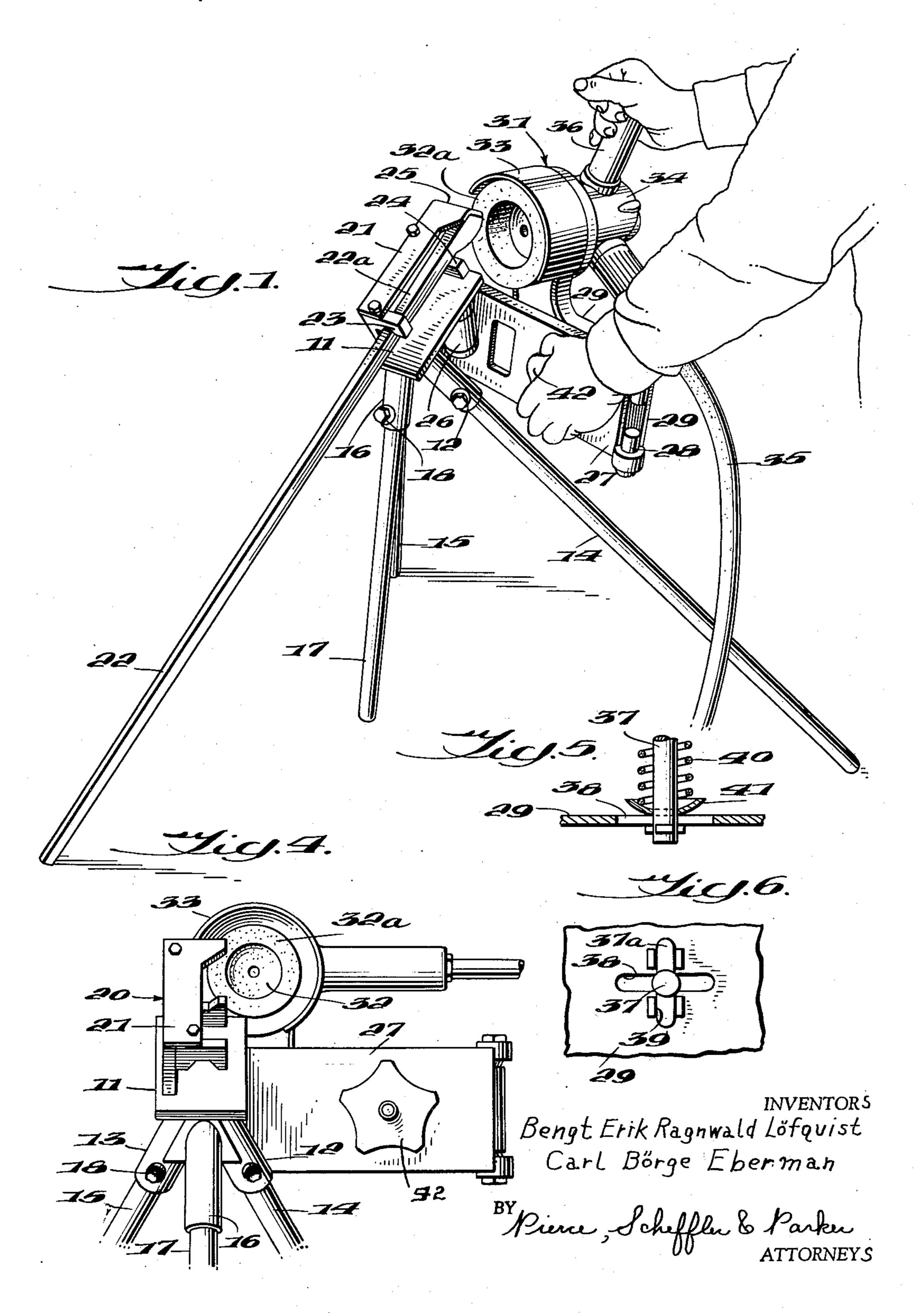
GRINDING STAND FOR ROCK DRILLS
