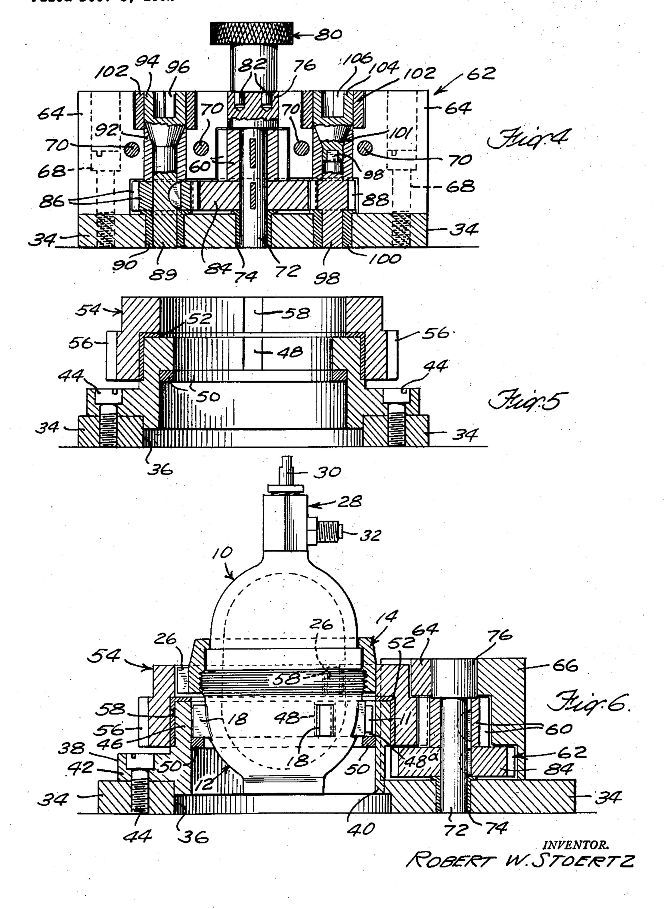
OPERATING JIG FOR CALORIMETER BOMB
