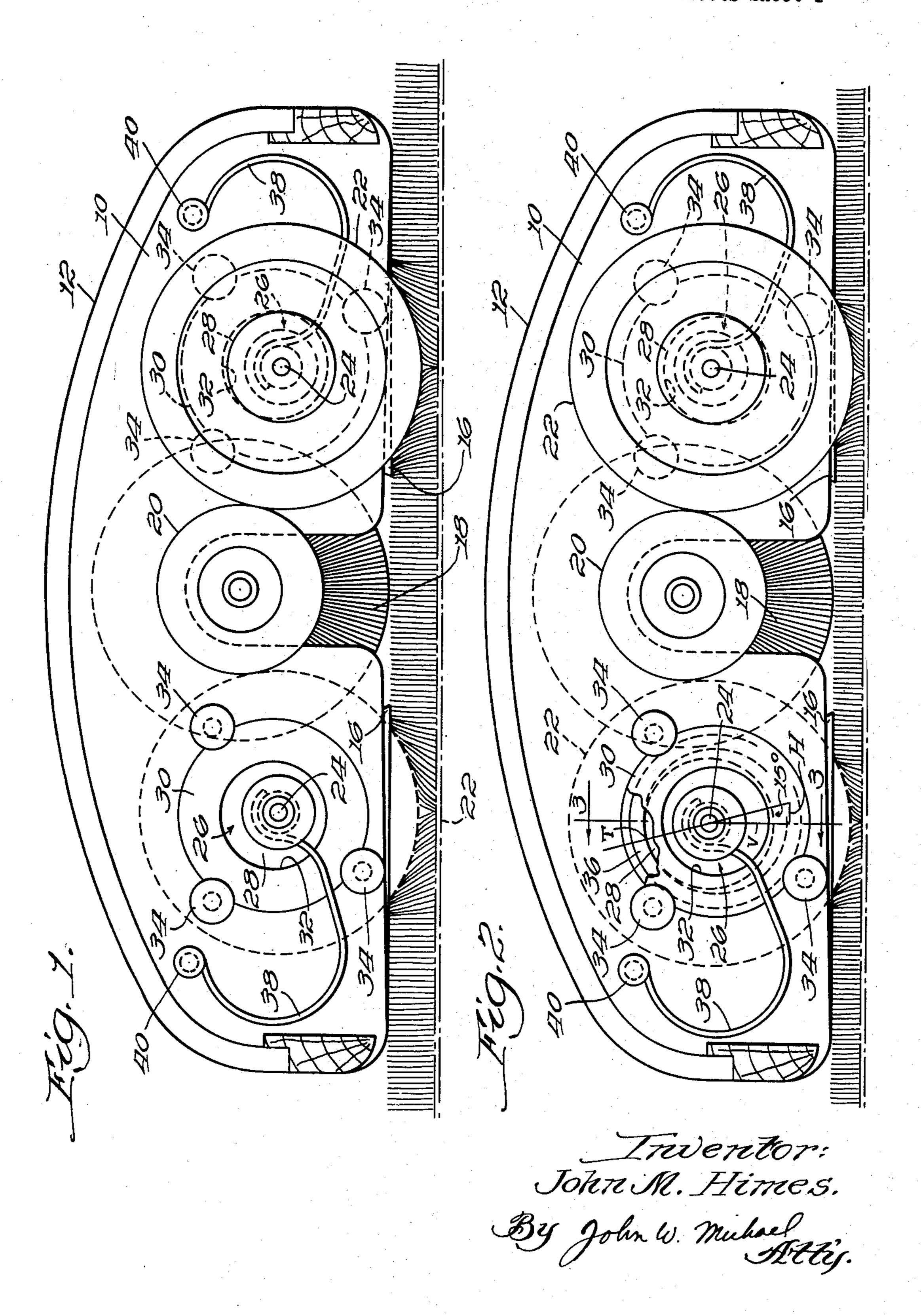
PLANETARY WHEEL SUSPENSION FOR CARPET SWEEPERS
