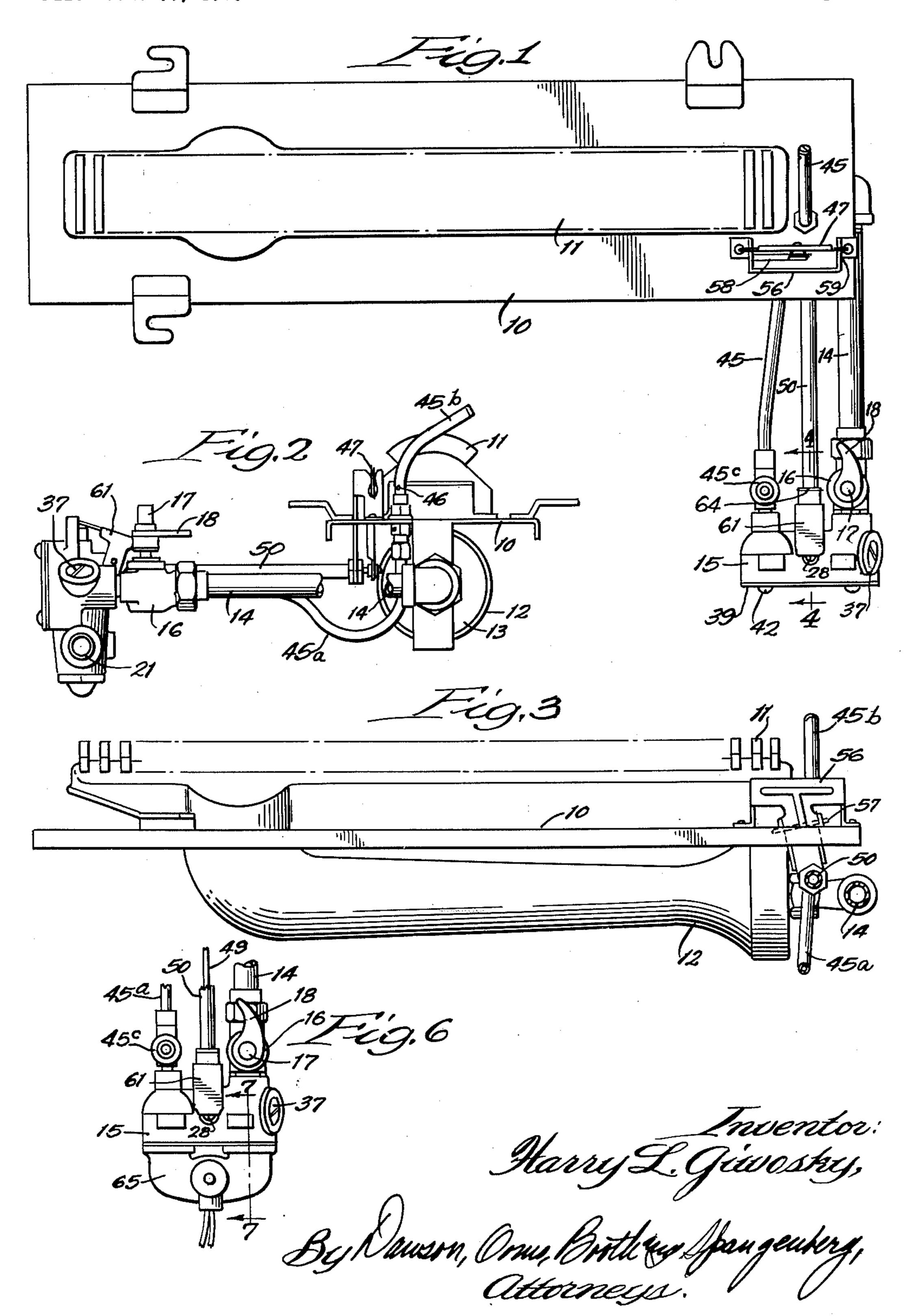
VALVE STRUCTURE FOR GAS BURNERS
