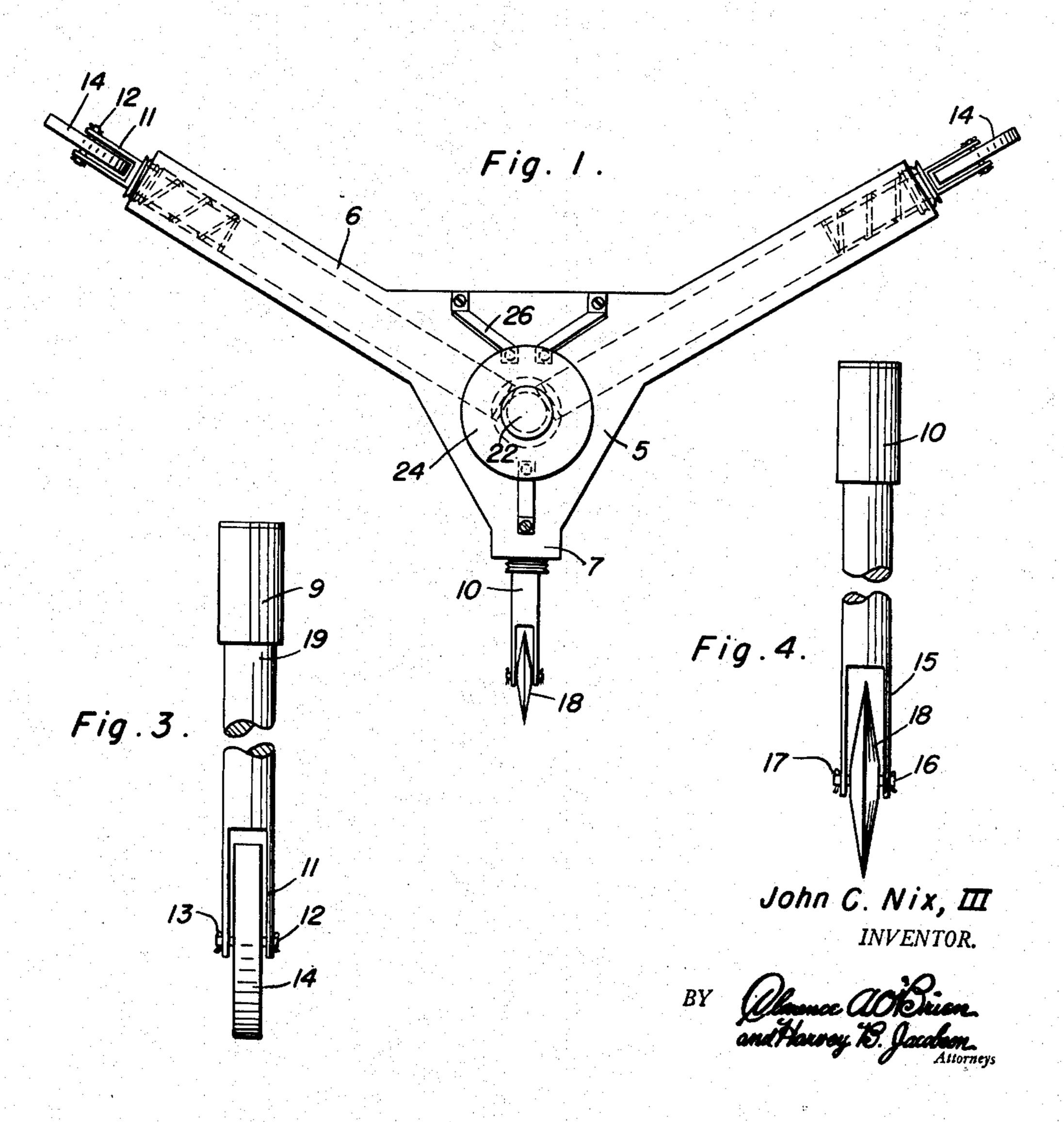
PAPER CUTTER FOR PAPER MILL DRYING ROLLERS
