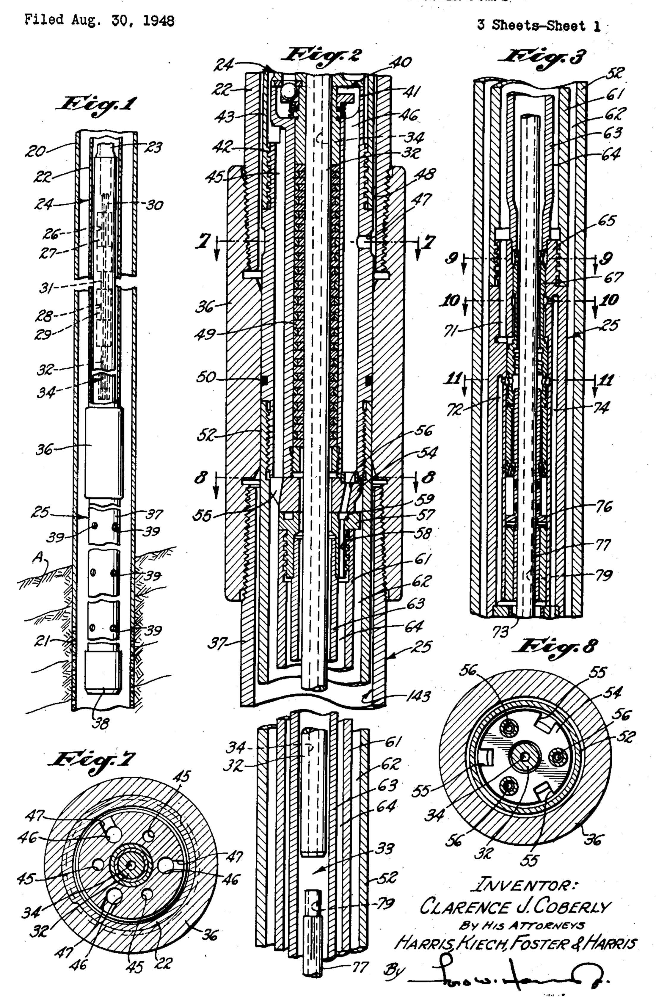
FLUID-OPERATED PUMP WITH TANDEM BOOSTER PUMPS
