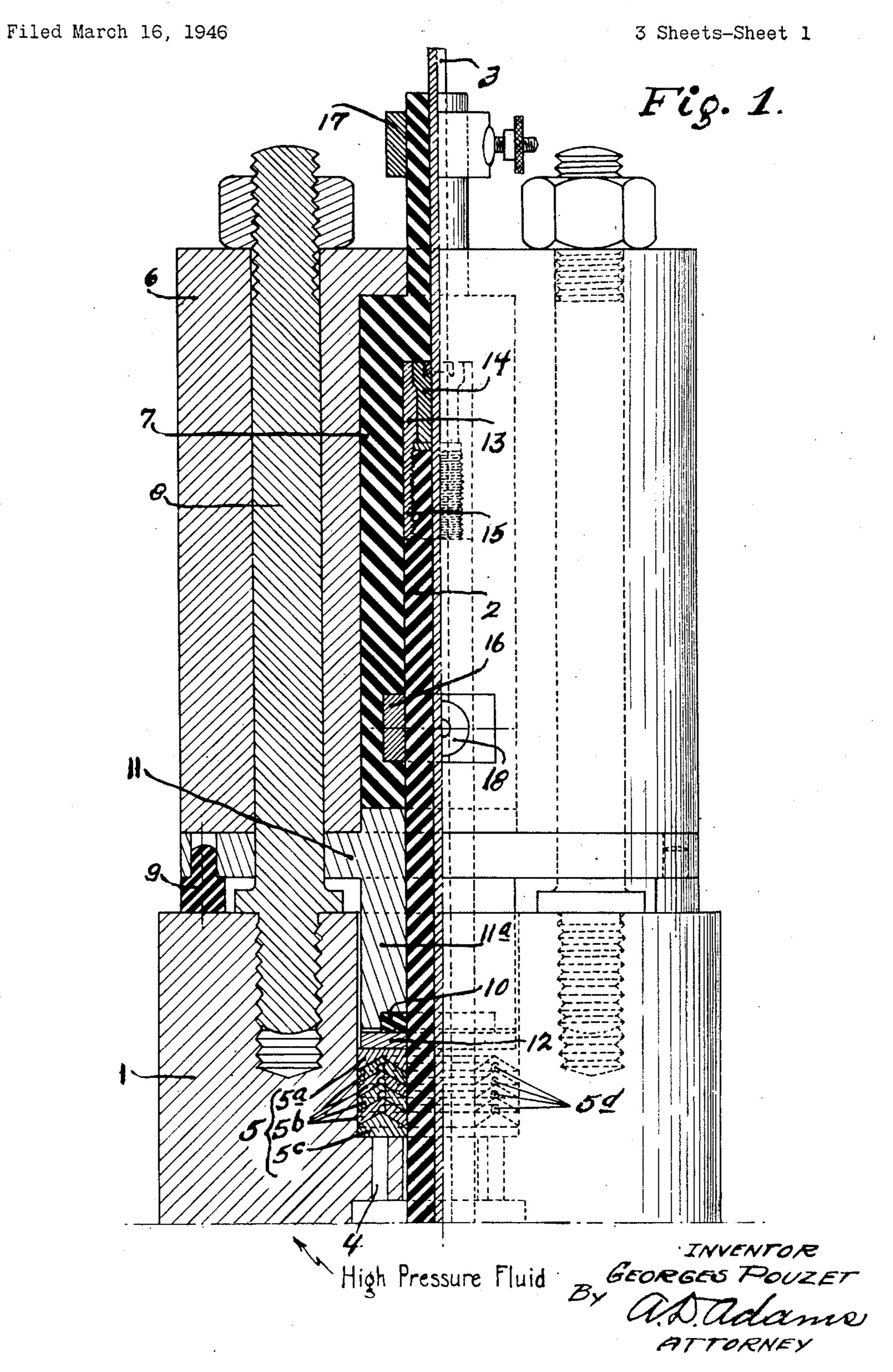
INSULATING HEAD FOR ELECTRIC CABLES UNDER HIGH-PRESSUE
