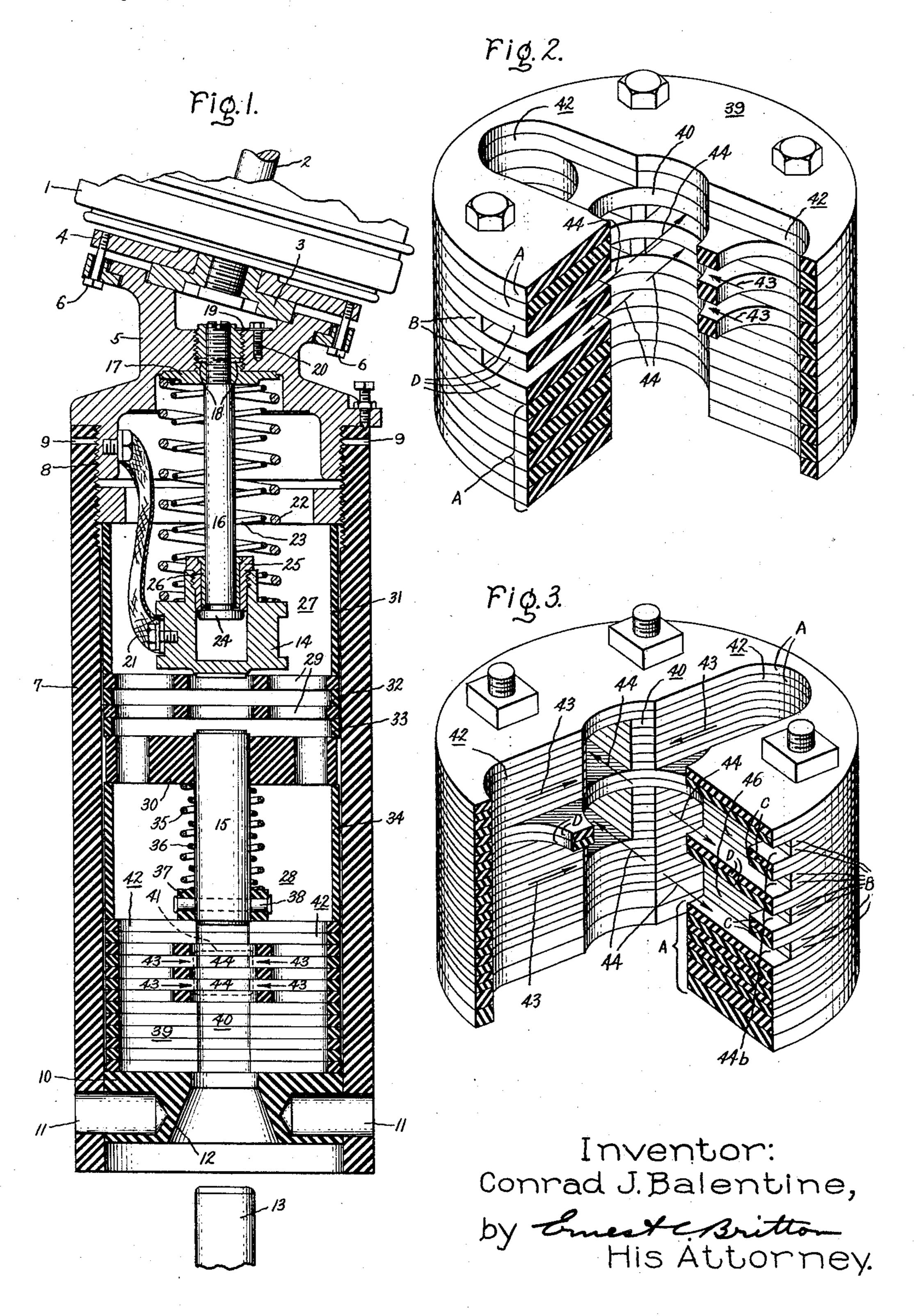
LIQUID BLAST INTERRUPTER FOR ELECTRIC BREAKERS
