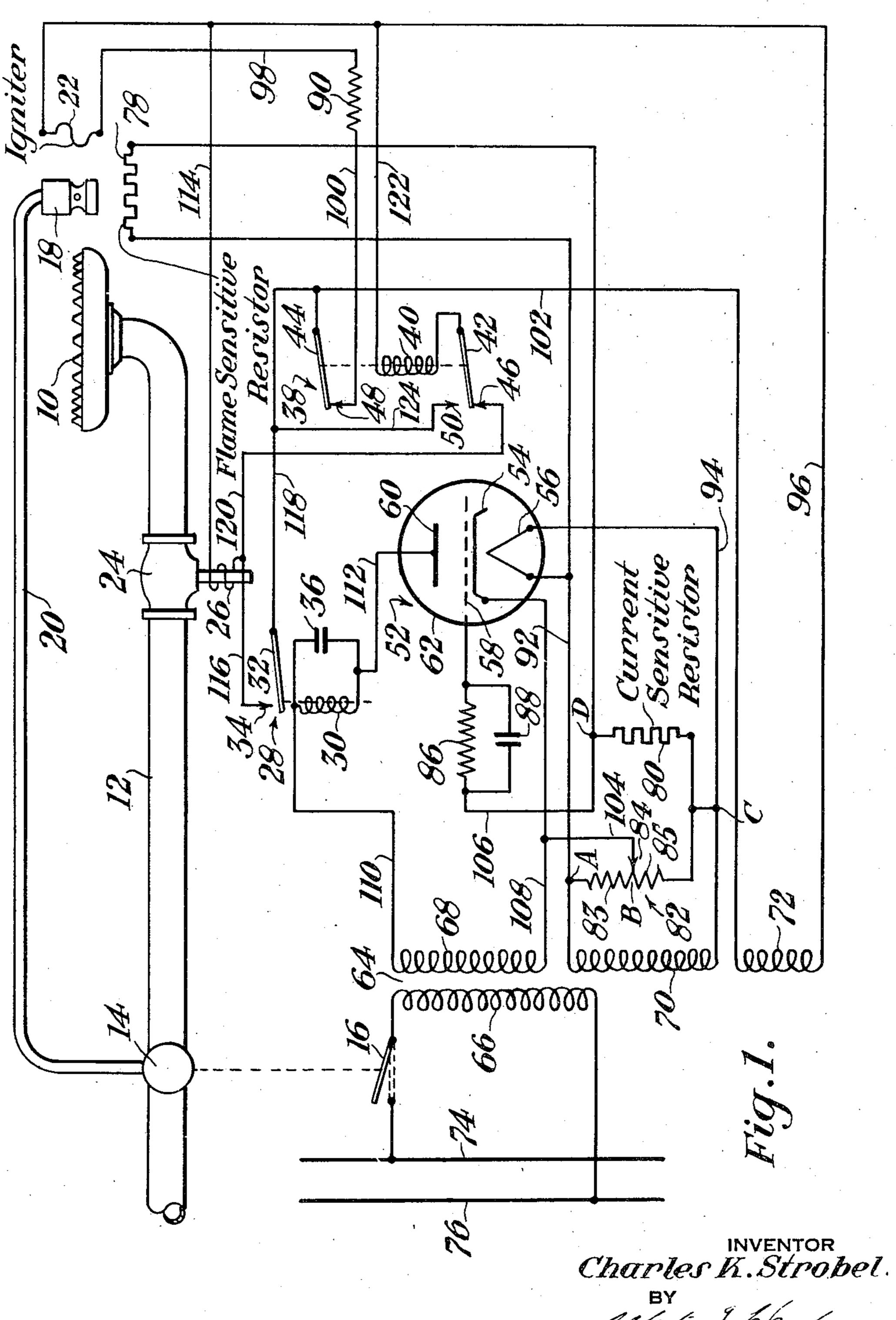
SAFETY CONTROL AND IGNITION SYSTEM FOR FUEL BURNERS
