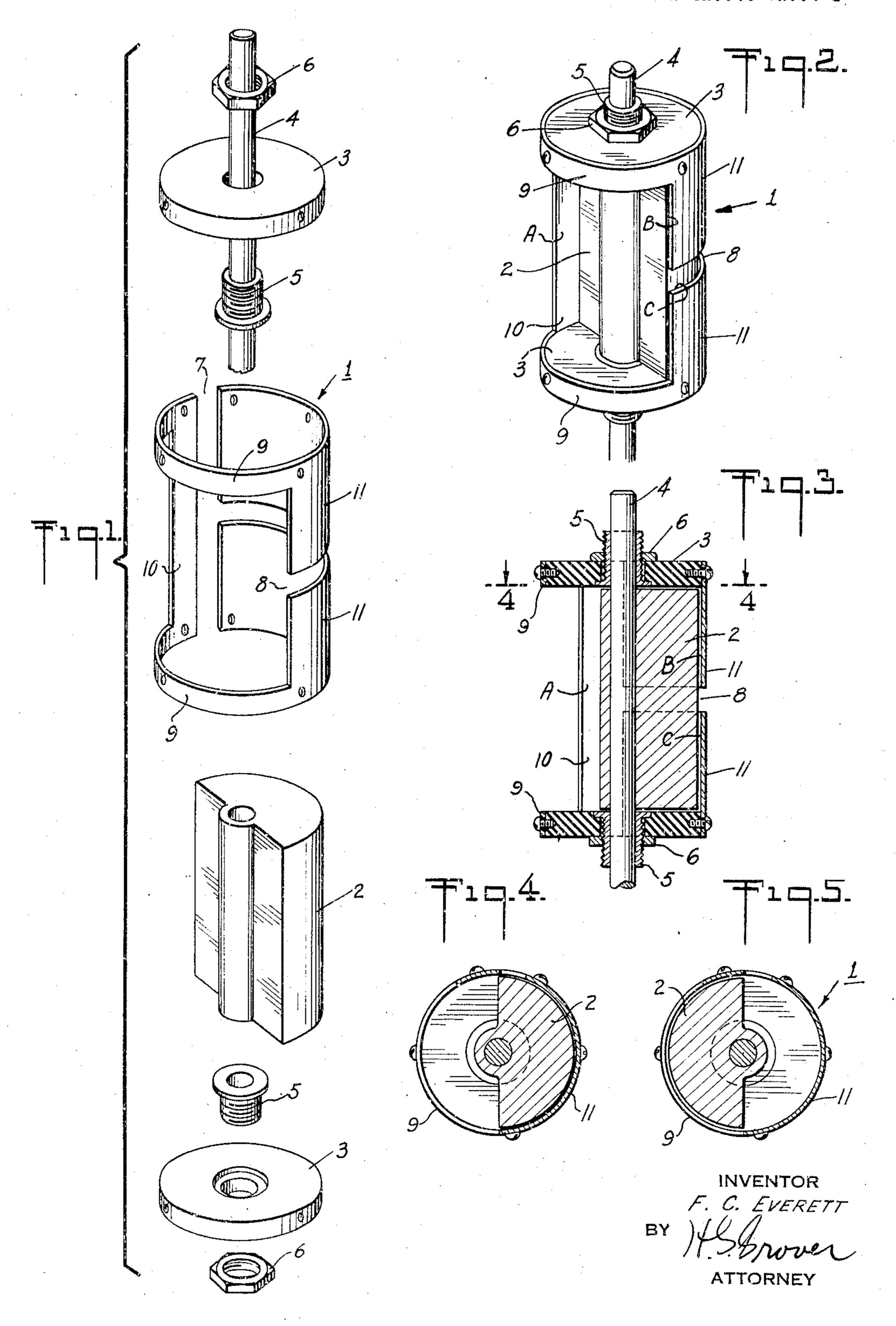
TUNABLE UNIT FOR HIGH-FREQUENCY CIRCUIT
