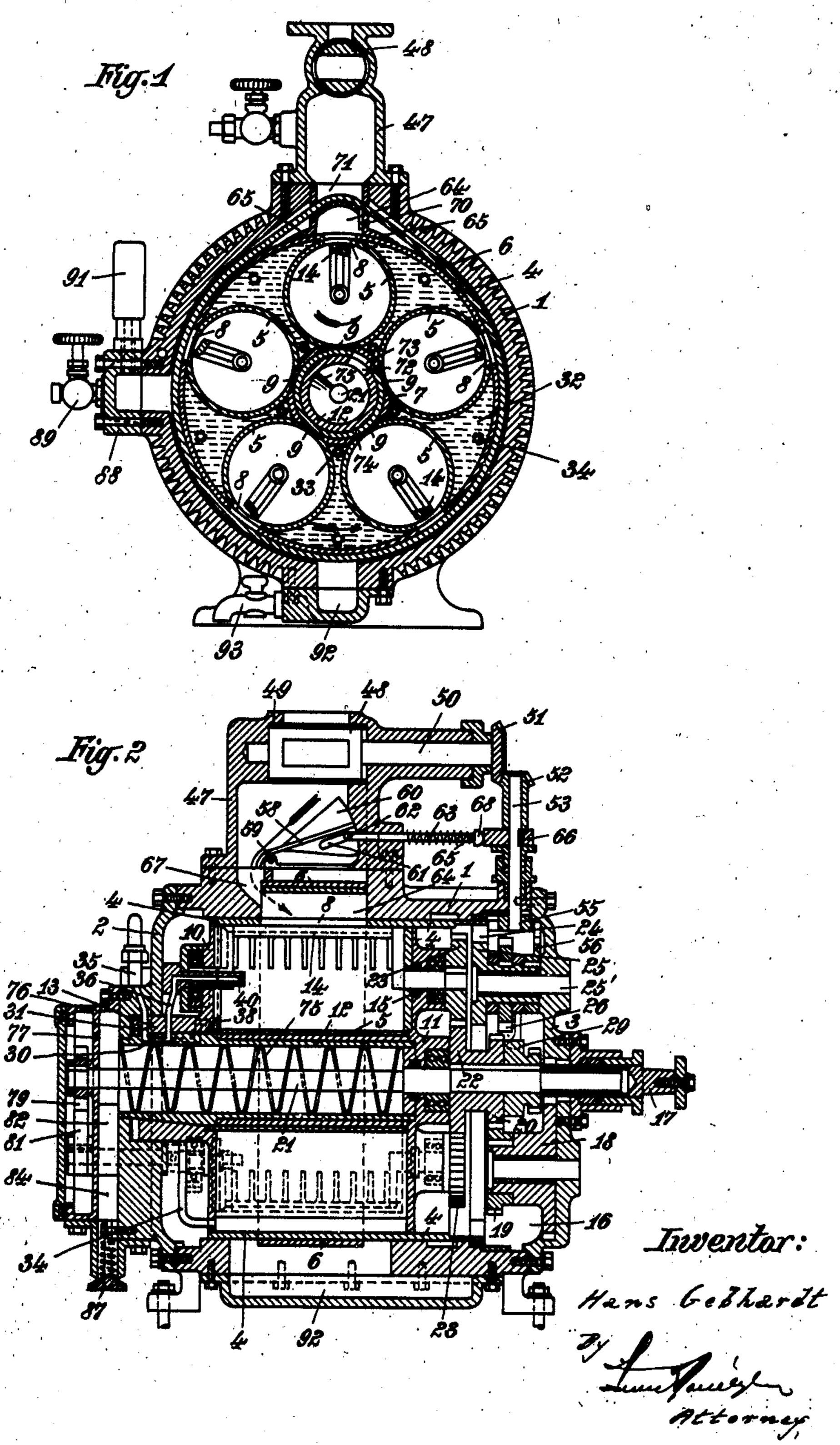
ACETYLENE GAS PRODUCING PLANT
