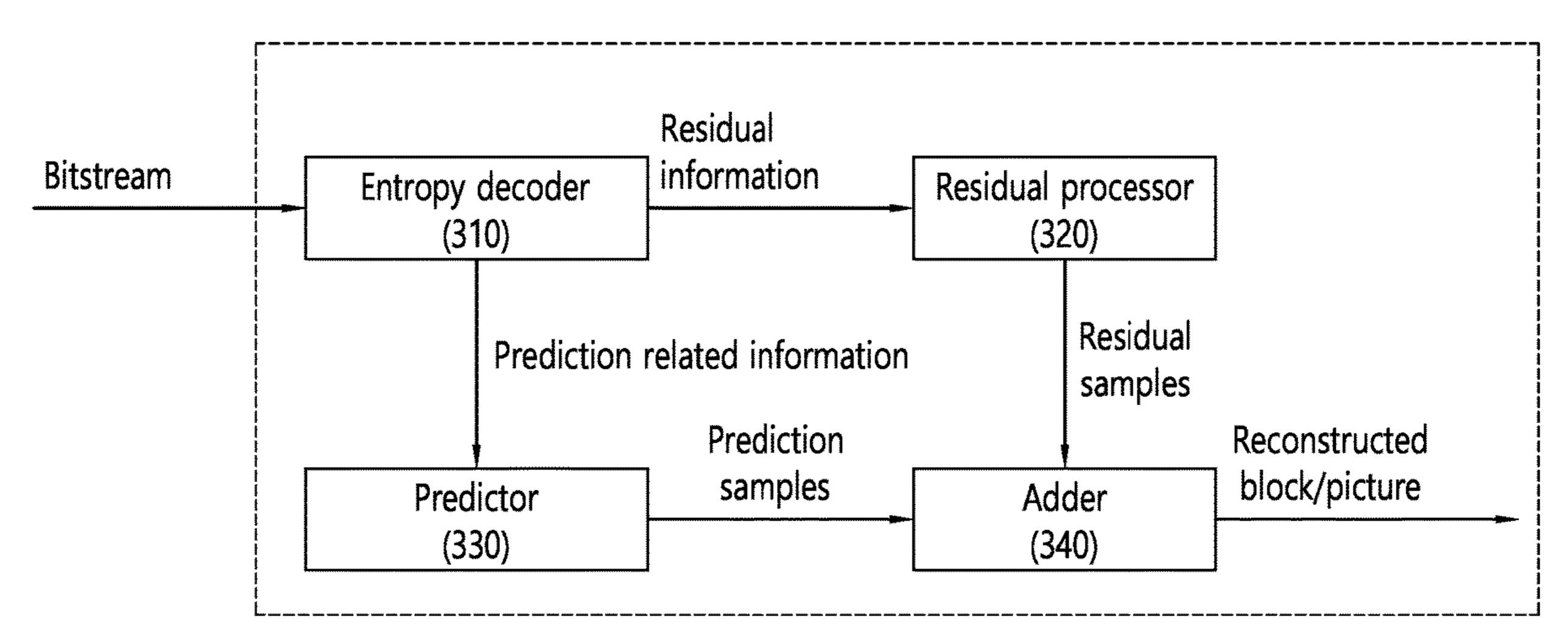
Decoding apparatus (300)
