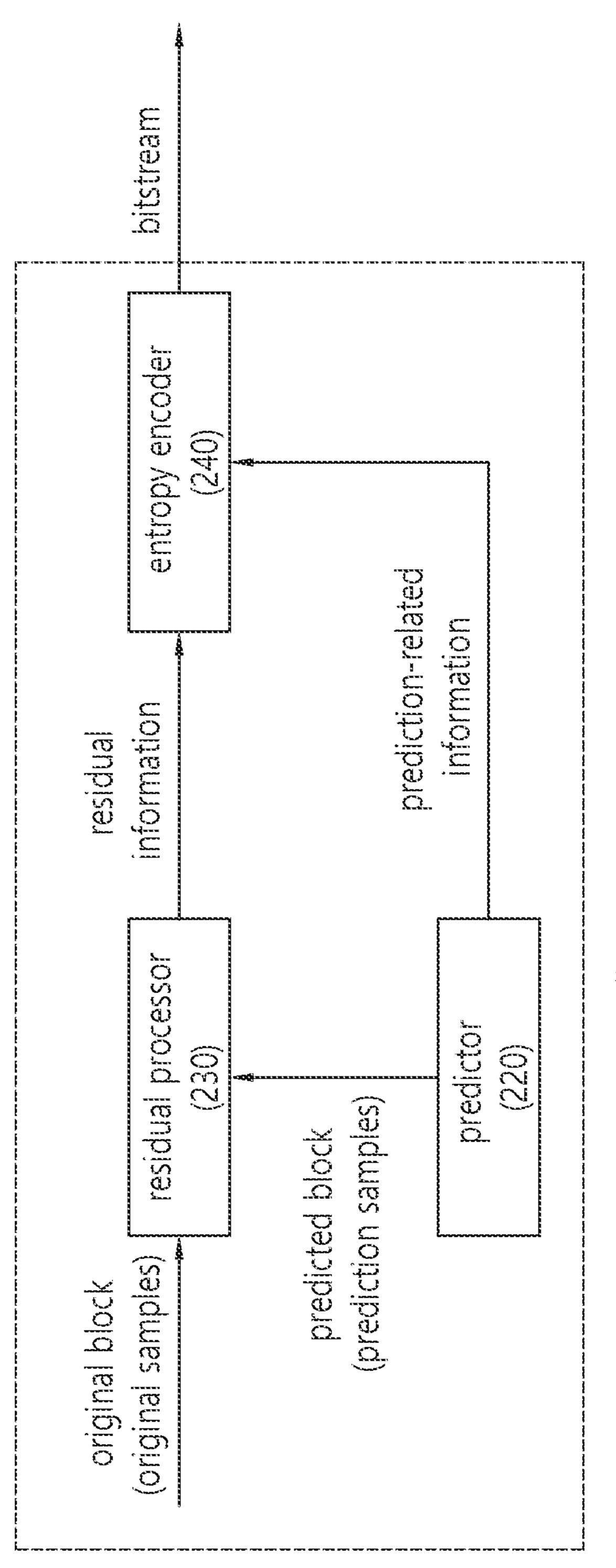
encoding apparatus (200)
