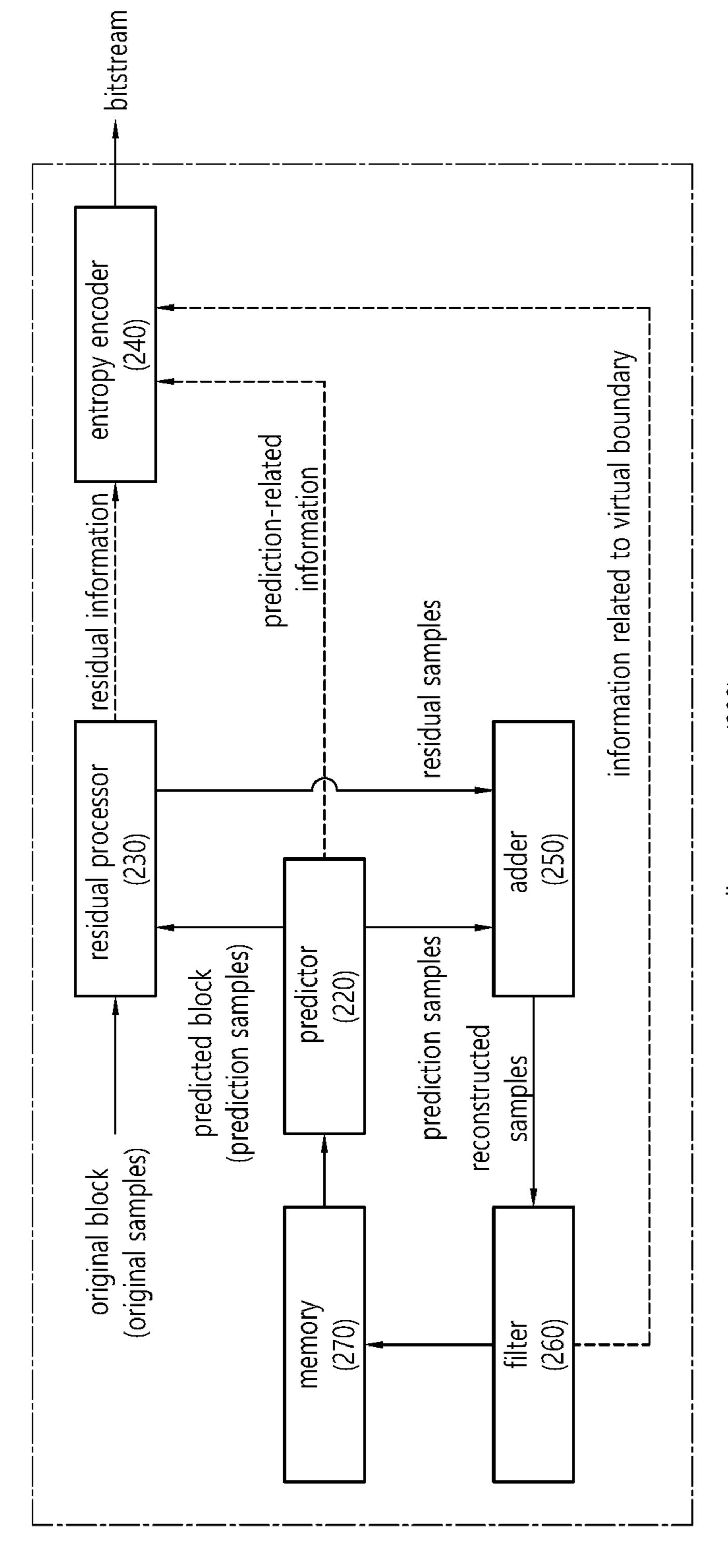
encoding apparatus (200)
