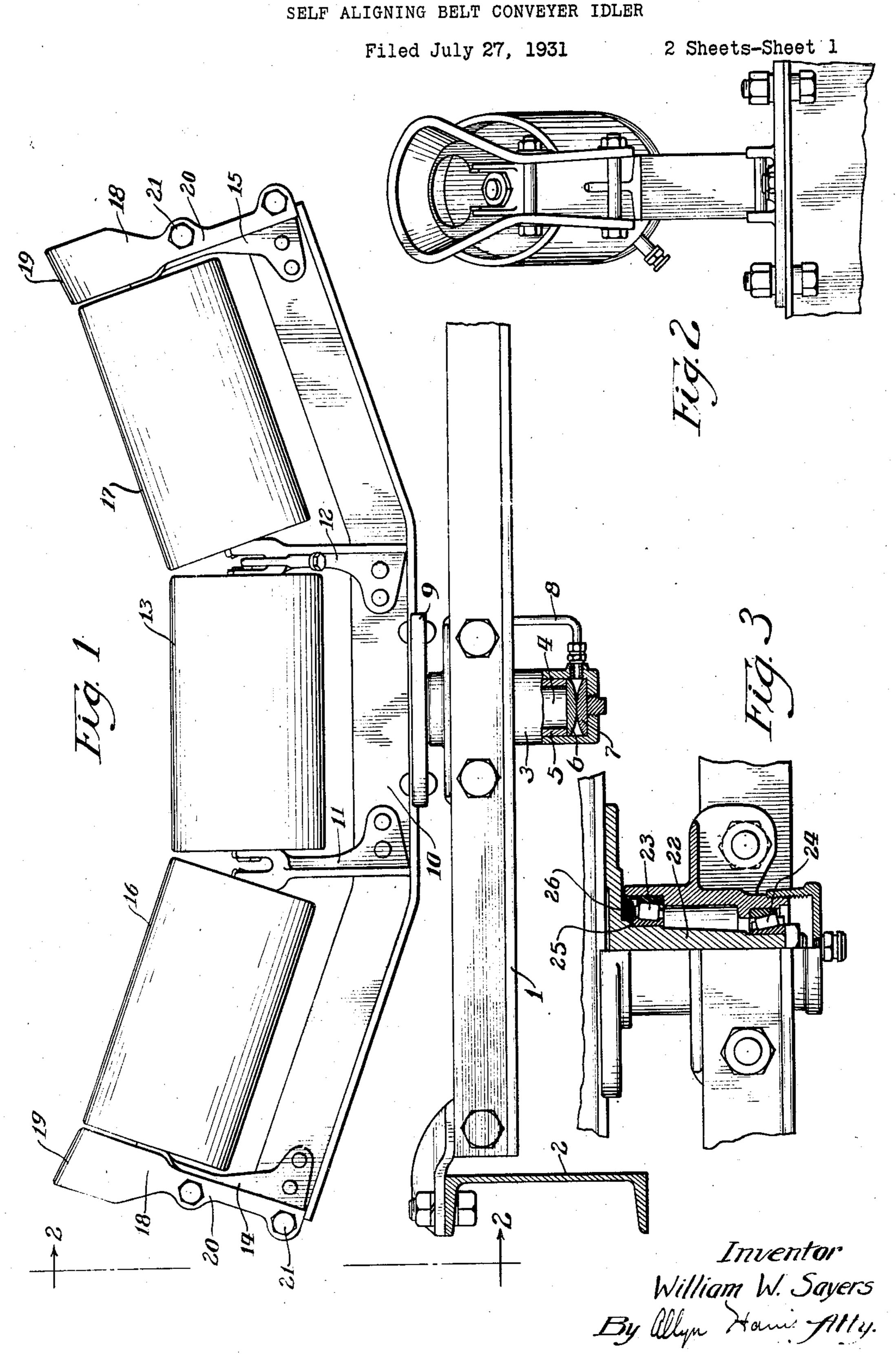
SELF ALIGNING BELT CONVEYER IDLER
