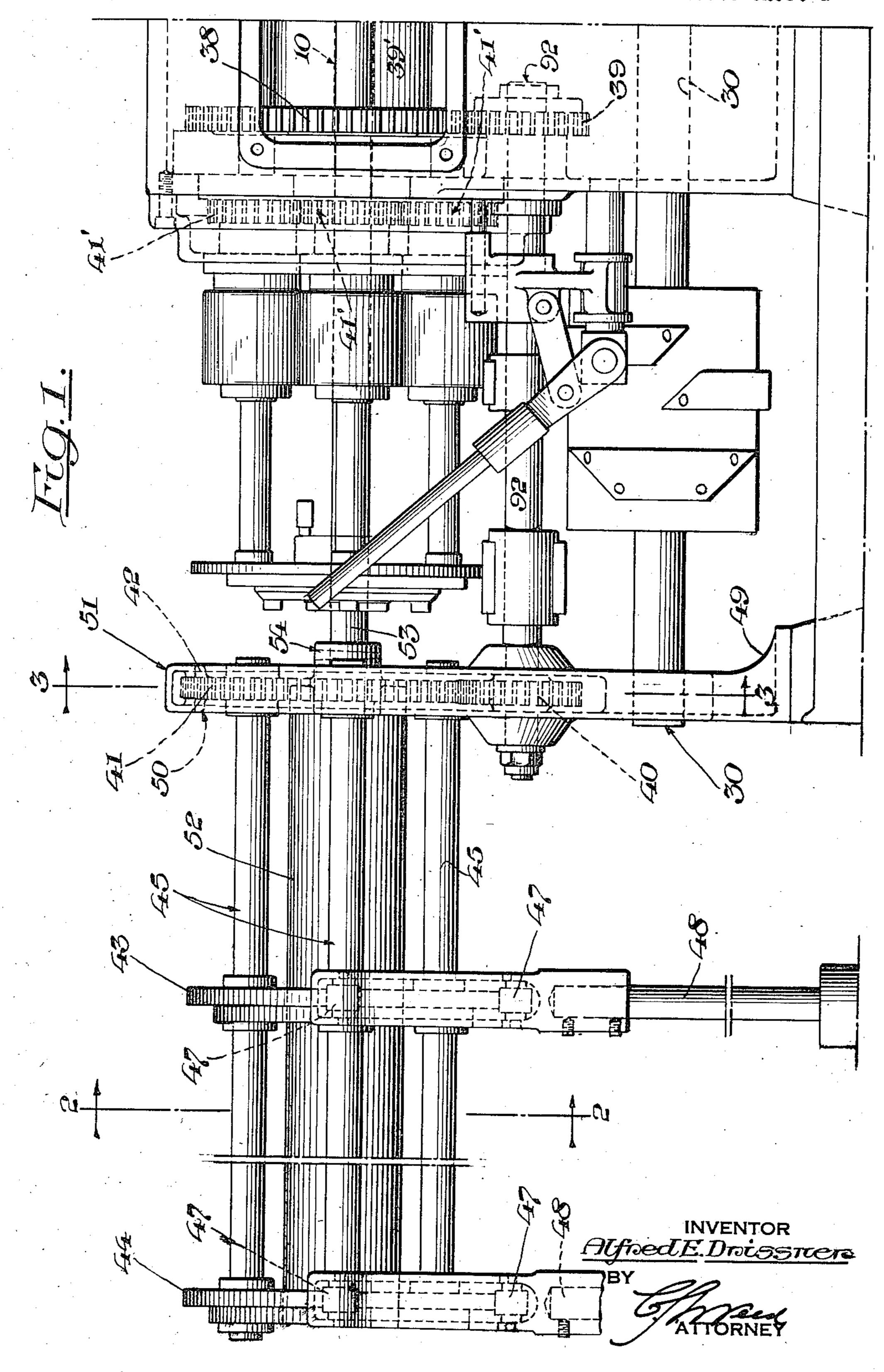
STOCK REEL FOR AUTOMATIC MULTIPLE SPINDLE SCREW MACHINES
