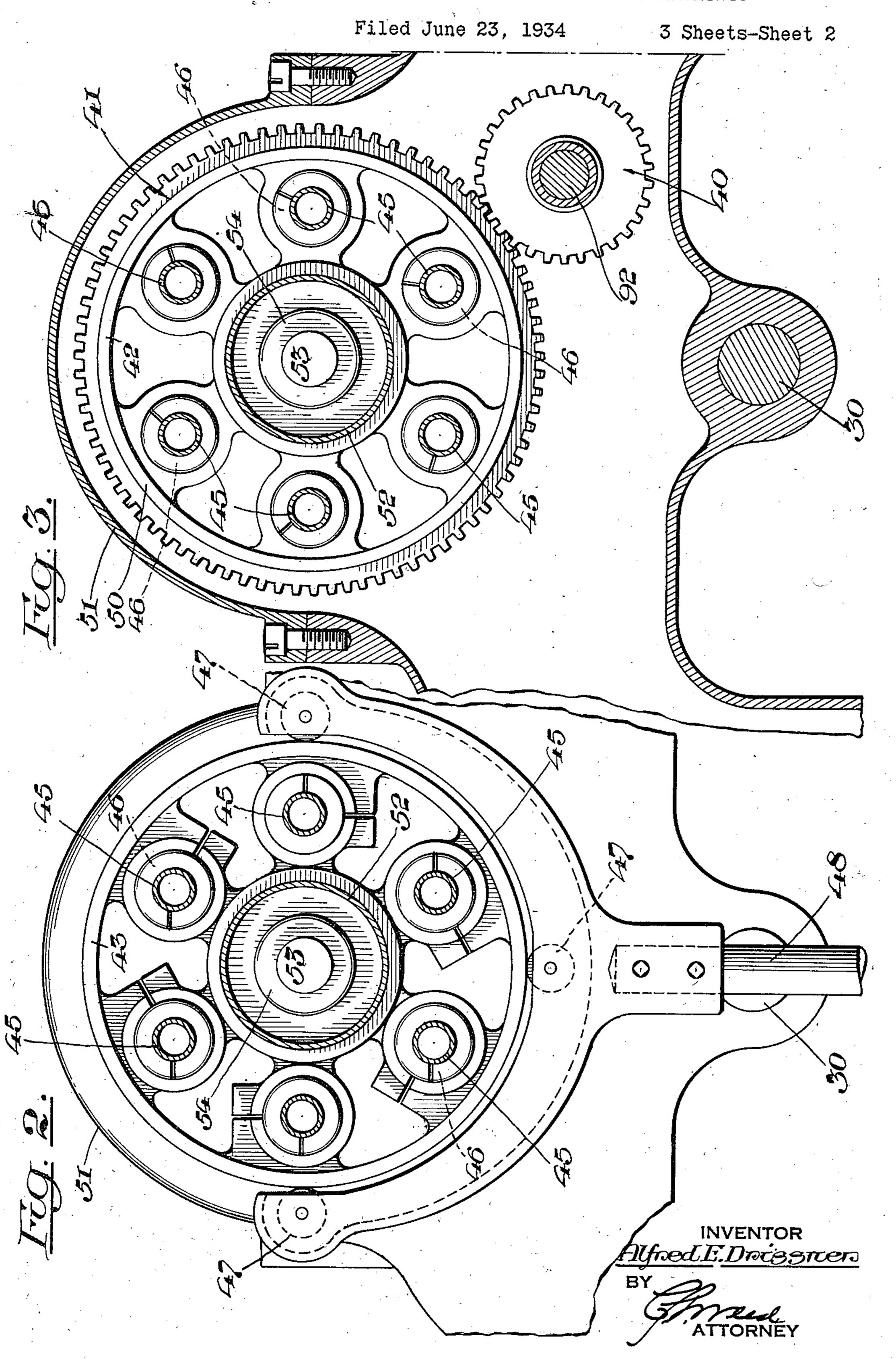
STOCK REEL FOR AUTOMATIC MULTIPLE SPINDLE SCREW MACHINES
