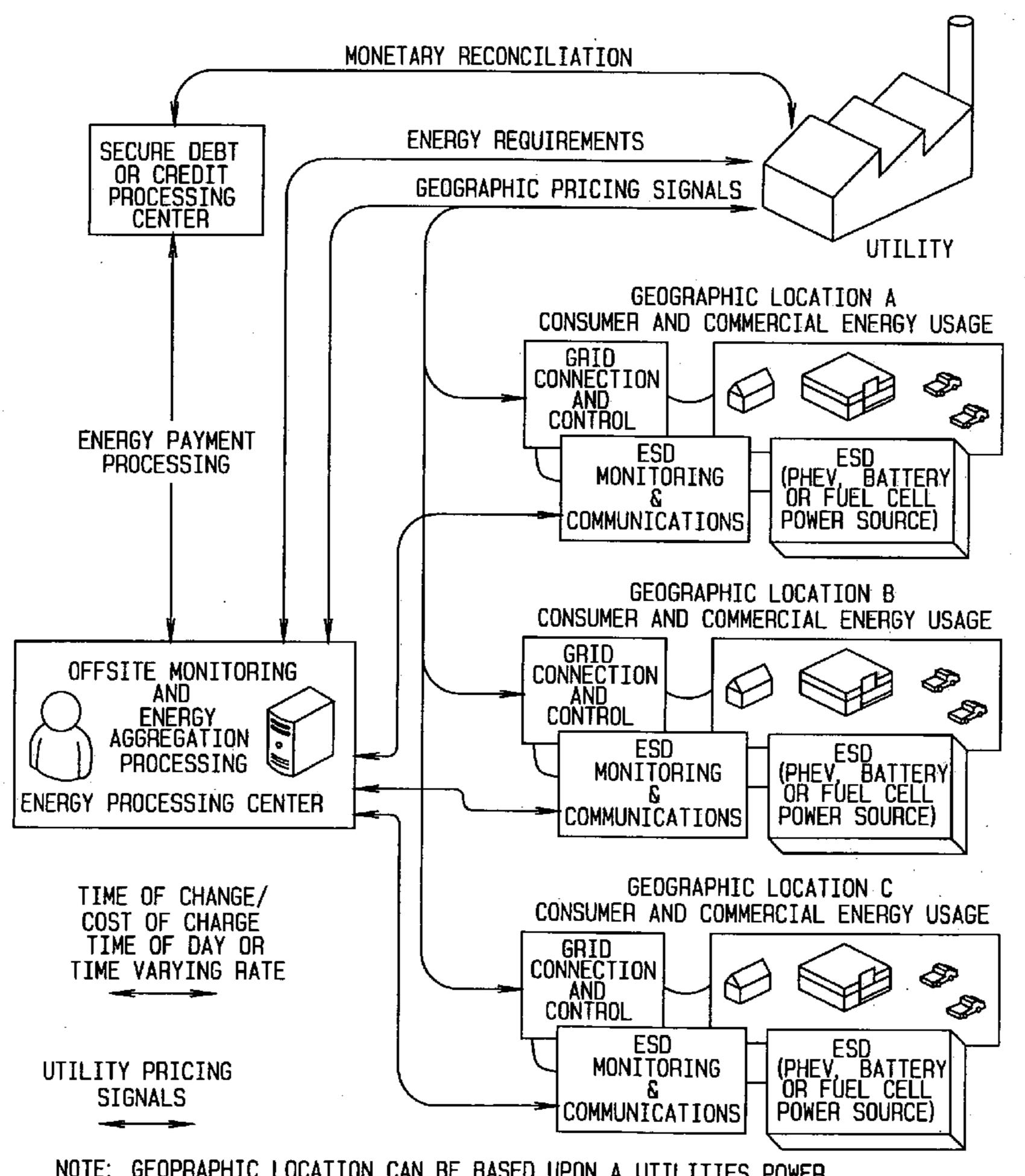
NOTE: GEOPRAPHIC LOCATION CAN BE BASED UPON A UTILITIES POWER DISTRIBUTION NETWORK, SUBSTATION LOCATION, COMMUNITY SERVED, OR POWER REQUIREMENT FOR A SPECIFIC LOCATION.
