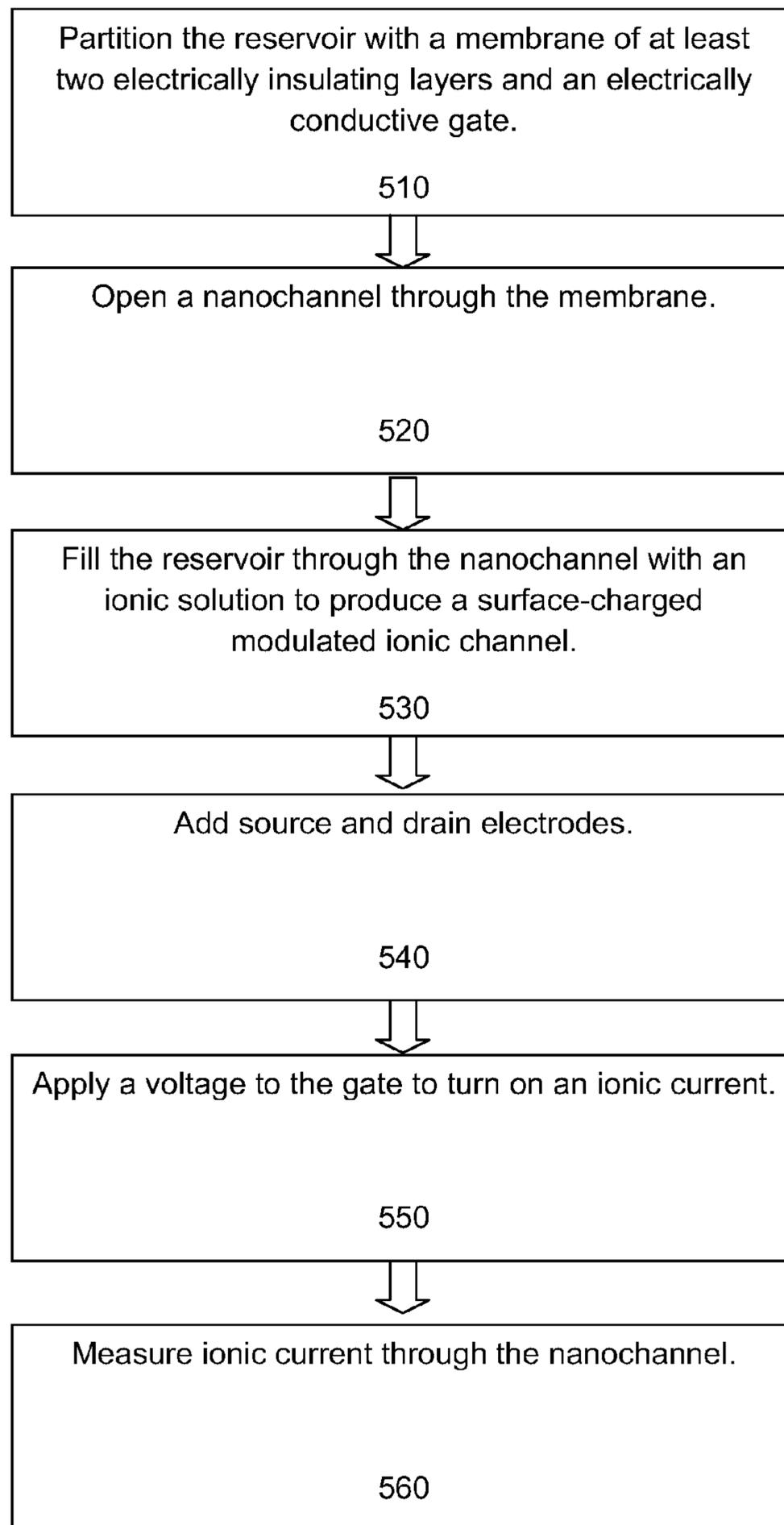
**NANOFLUIDIC FIELD EFFECT TRANSISTOR
