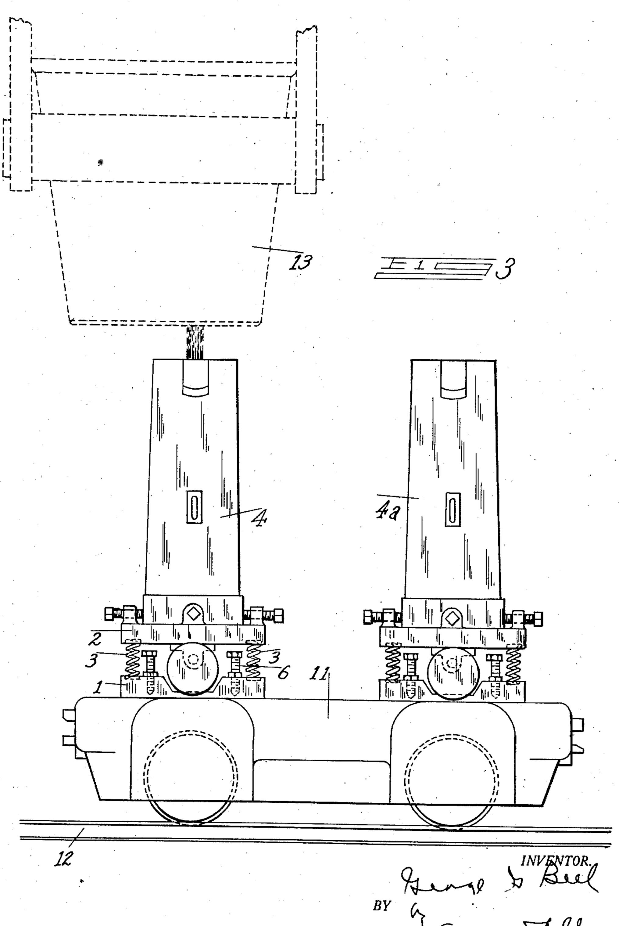
SHAKER FOR INGOT MOLDS
