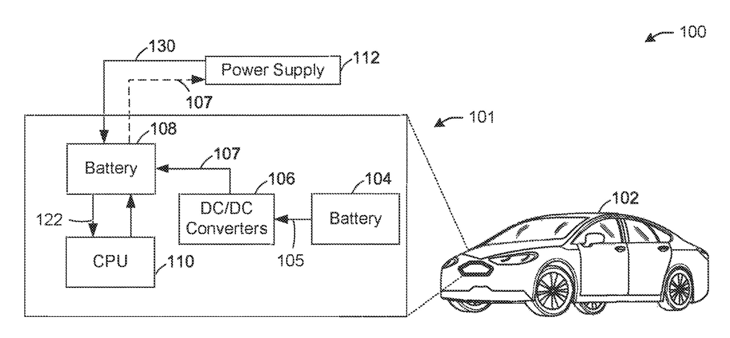
[[POWER 107 BACKFEEDS INTO THE POWER SUPPLY 112 AND THE BATTERY 108 DRAINS]]
