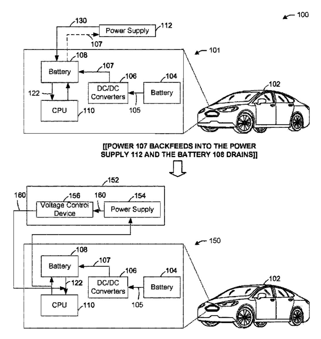
[[POWER 107 DOES NOT BACKFEED TO THE VOLTAGE MAINTAINER 152, AND THE VOLTAGE MAINTAINER 152 MAINTAINS THE VOLTAGE OF THE BATTERY 108]]
