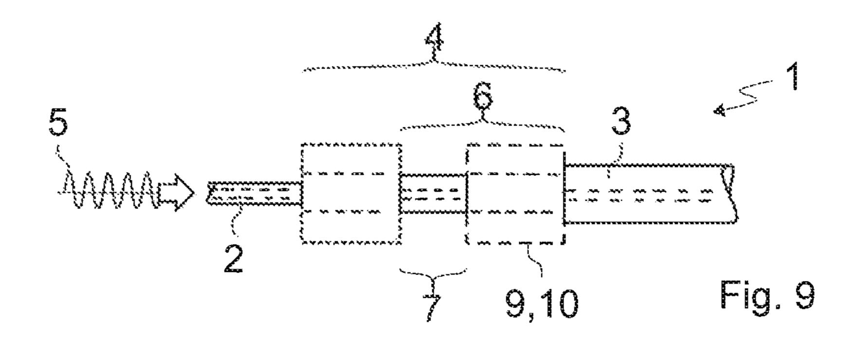
WAVEGUIDE ASSEMBLY COMPRISING A DIELECTRIC WAVEGUIDE TRANSITION PIECE OF CHANGING SIZE LOCATED BETWEEN A FIRST WAVEGUIDE AND A SECOND DIELECTRIC WAVEGUIDE TO REDUCE HIGHER MODES
