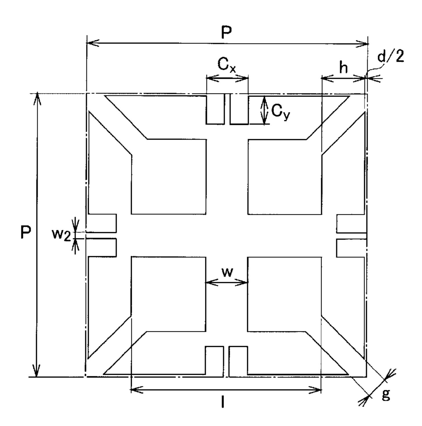
THICKNESS t: 1.3  $\mu$  m , p: 10mm l : 6.8mm , d: 0.2mm g : 0.8mm , w: 1.5mm w<sub>2</sub> : 0.2mm , c<sub>x</sub>: 1.5mm c<sub>y</sub> : 1.0mm , h: 1.5mm
