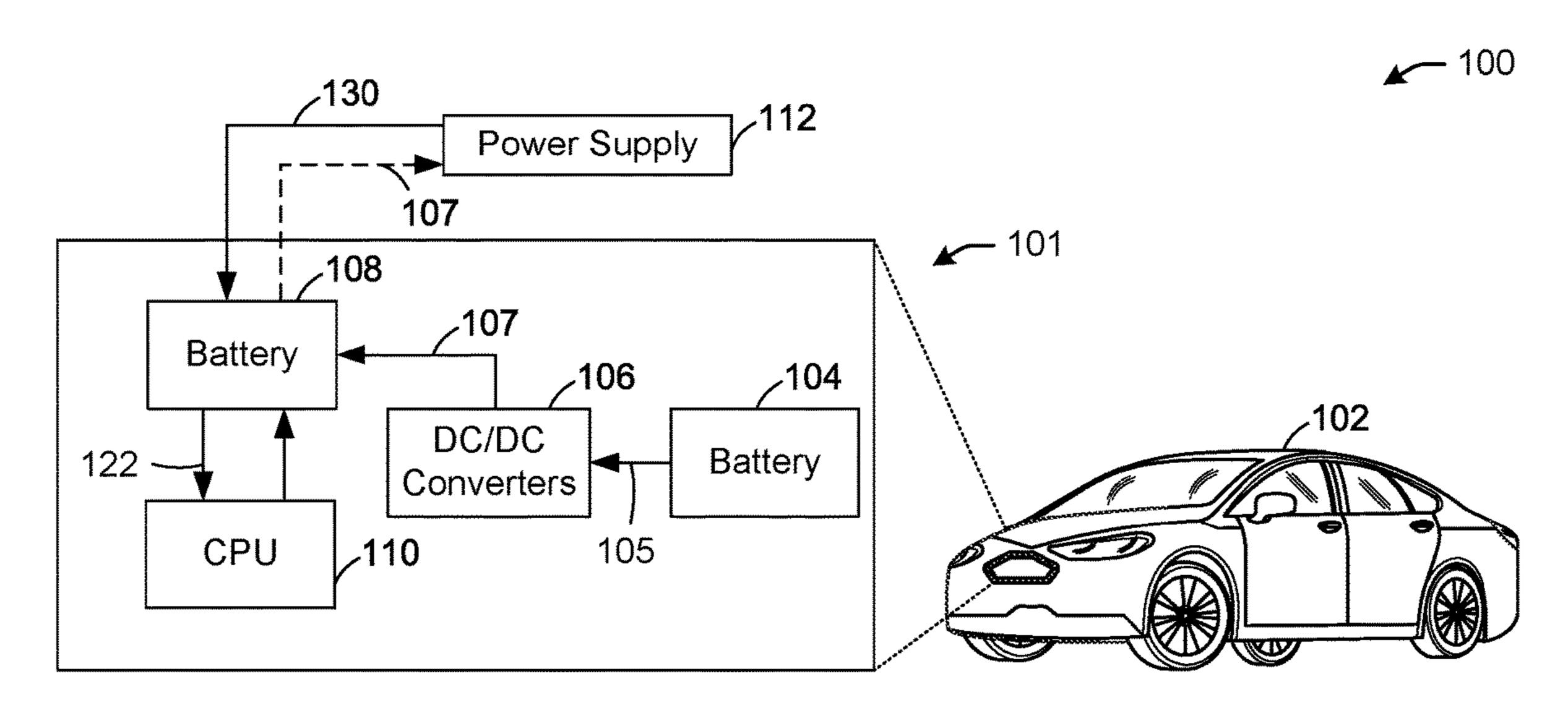
[[POWER 107 BACKFEEDS INTO THE POWER SUPPLY 112 AND THE BATTERY 108 DRAINS]]
