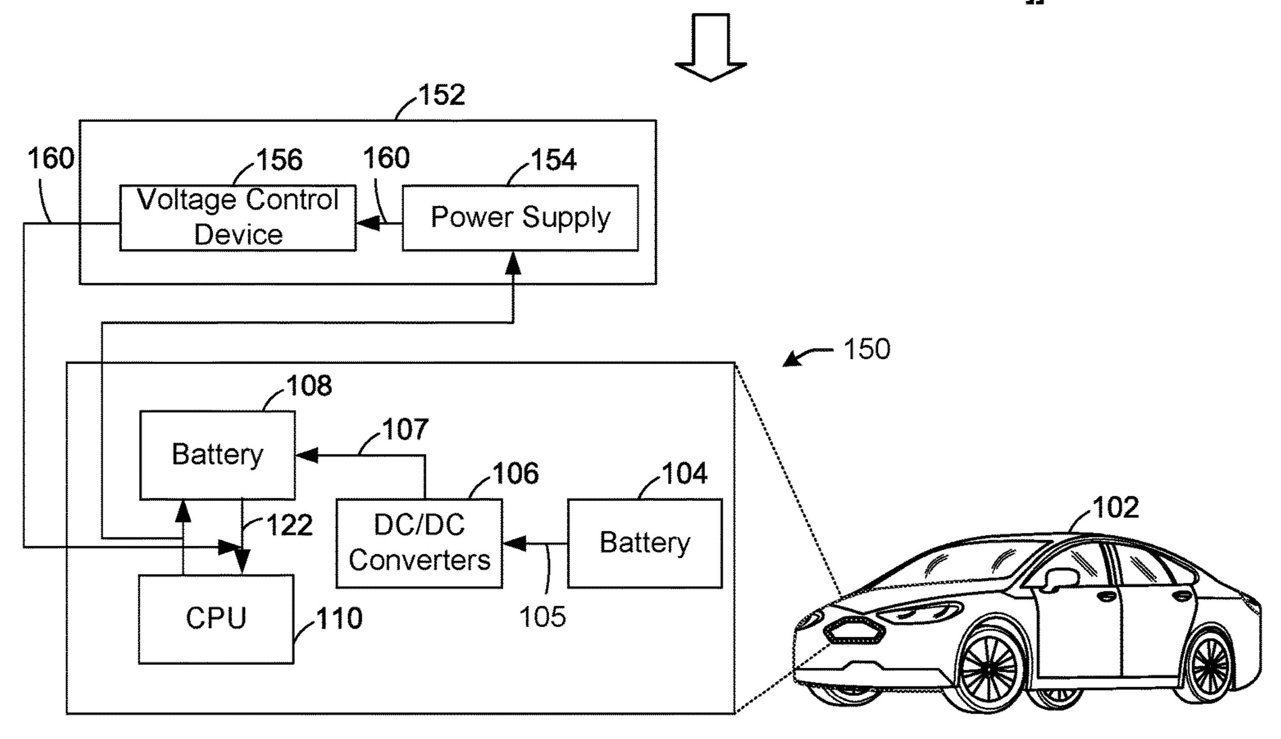
[[POWER 107 DOES NOT BACKFEED TO THE VOLTAGE MAINTAINER 152, AND THE VOLTAGE MAINTAINER 152 MAINTAINS THE VOLTAGE OF THE BATTERY 108]]
