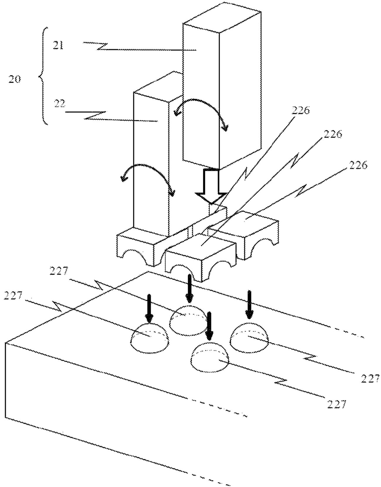
**LIQUID MATERIAL EJECTION DEVICE**
