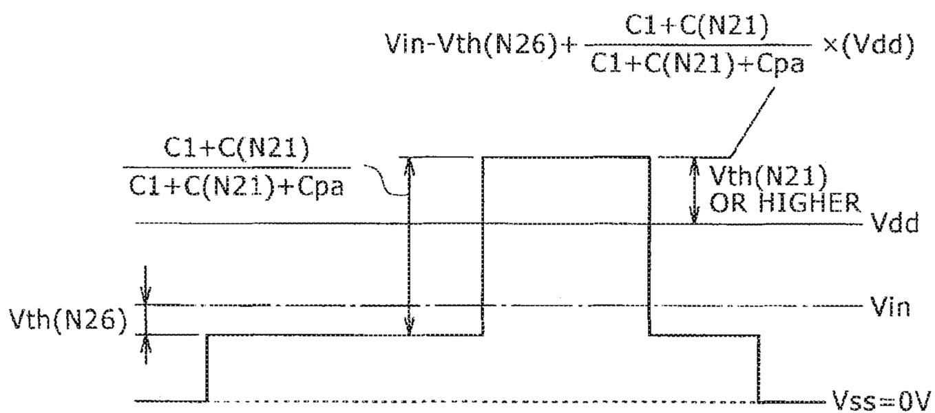
$$V_{in} - V_{th}(N26) + \frac{C1 + C(N21)}{C1 + C(N21) + C_{pa}} \times (V_{dd}) - V_{dd} > V_{th}(N21)$$
