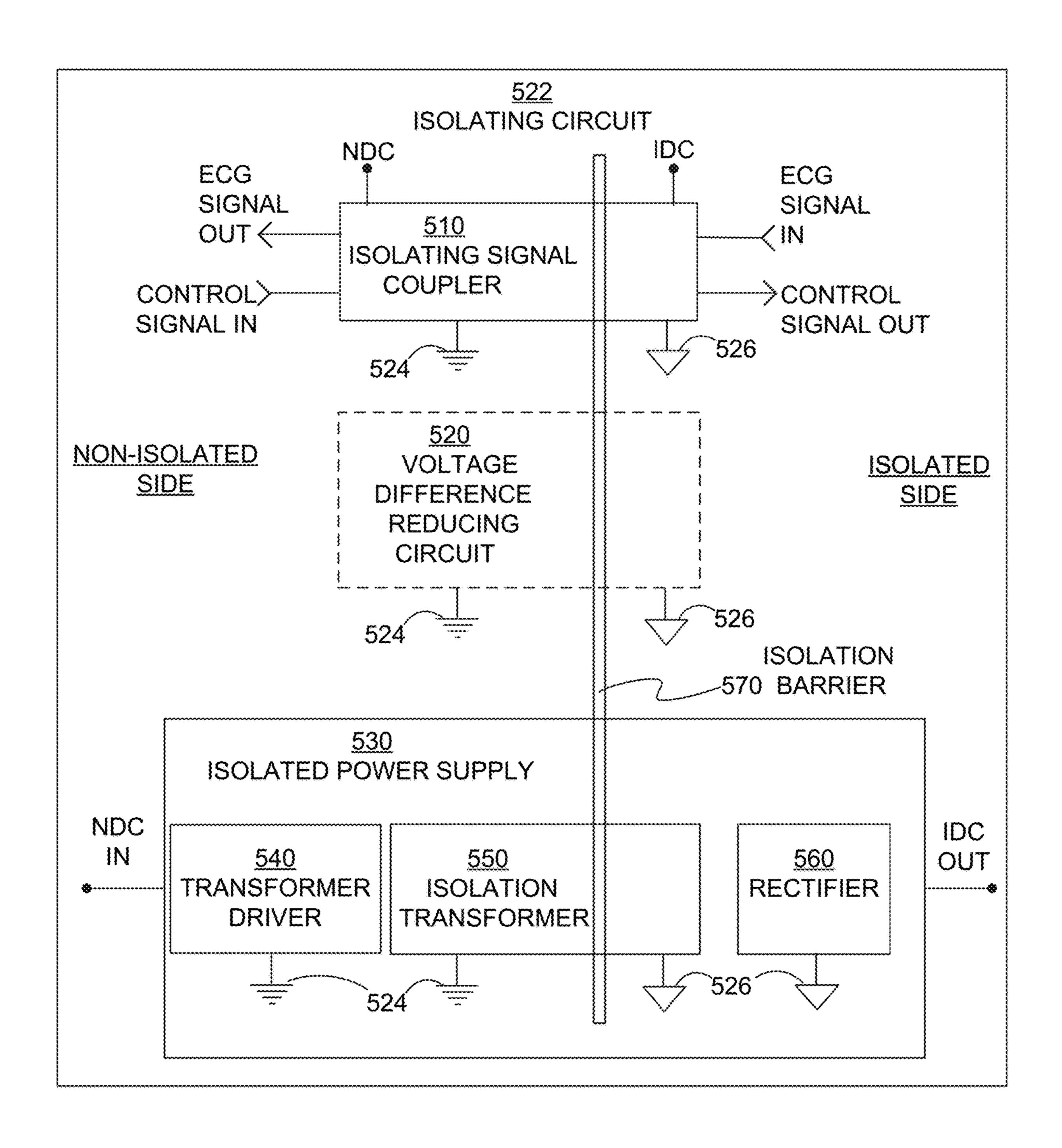
SAMPLE COMPONENTS OF ISOLATING CIRCUIT
