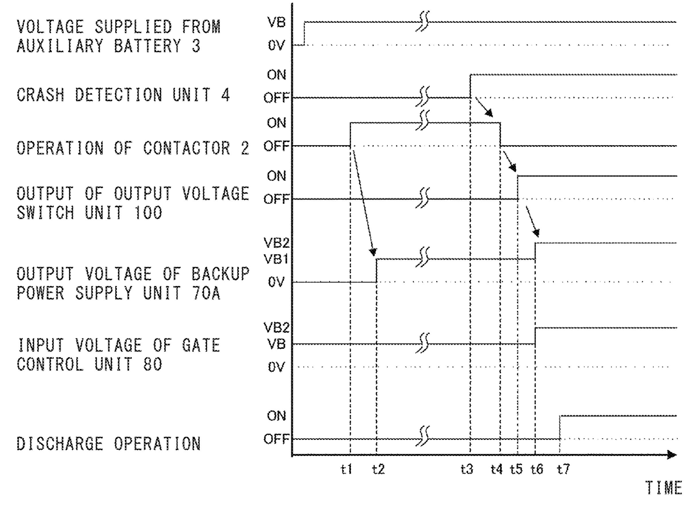
\* OPERATION LOWER-LIMIT VOLTAGE OF POWER CONTROL DEVICE 10 < VB1 < VB < VB2
