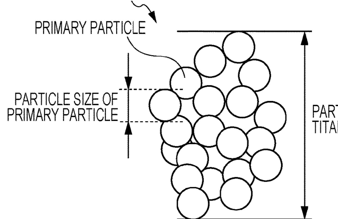
PARTICLE SIZE OF TITANIUM OXIDE AEROGEL PARTICLE
