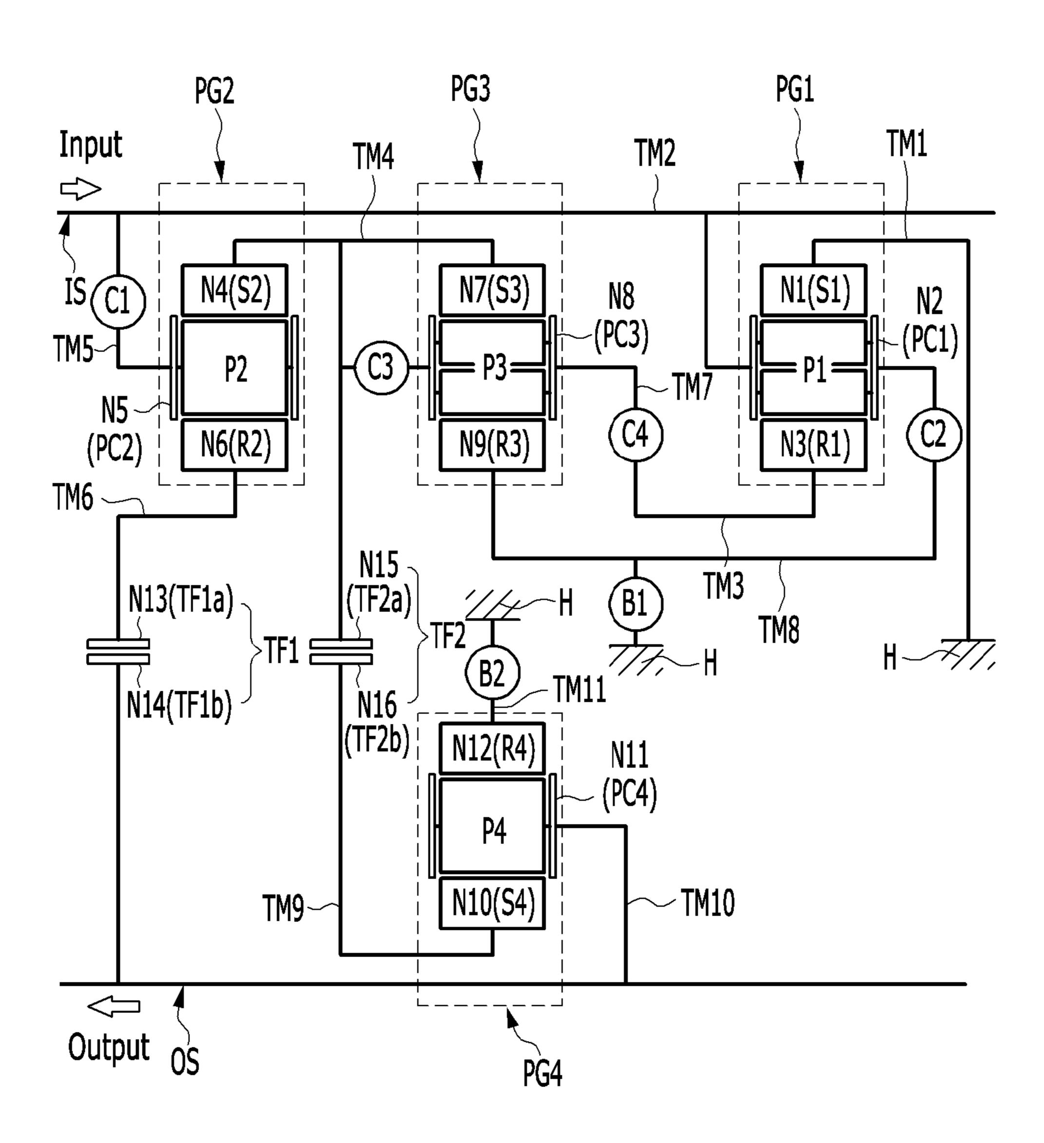
ratio span:8.79 Remark Step ratio 1.24 1.62 1.16 1.22 1.22 1.47 1.31 1.31 Gear ratio -4.19 5.12 2.14 1.25 3.15 1.63 0.58 1.01 0.87 0.71 **B**2 **Brake B1** 2 Clutch  $\mathcal{C}$ hift-stage REV 90 8 **D3 D**5 **D**2 60 **D**7 Z
