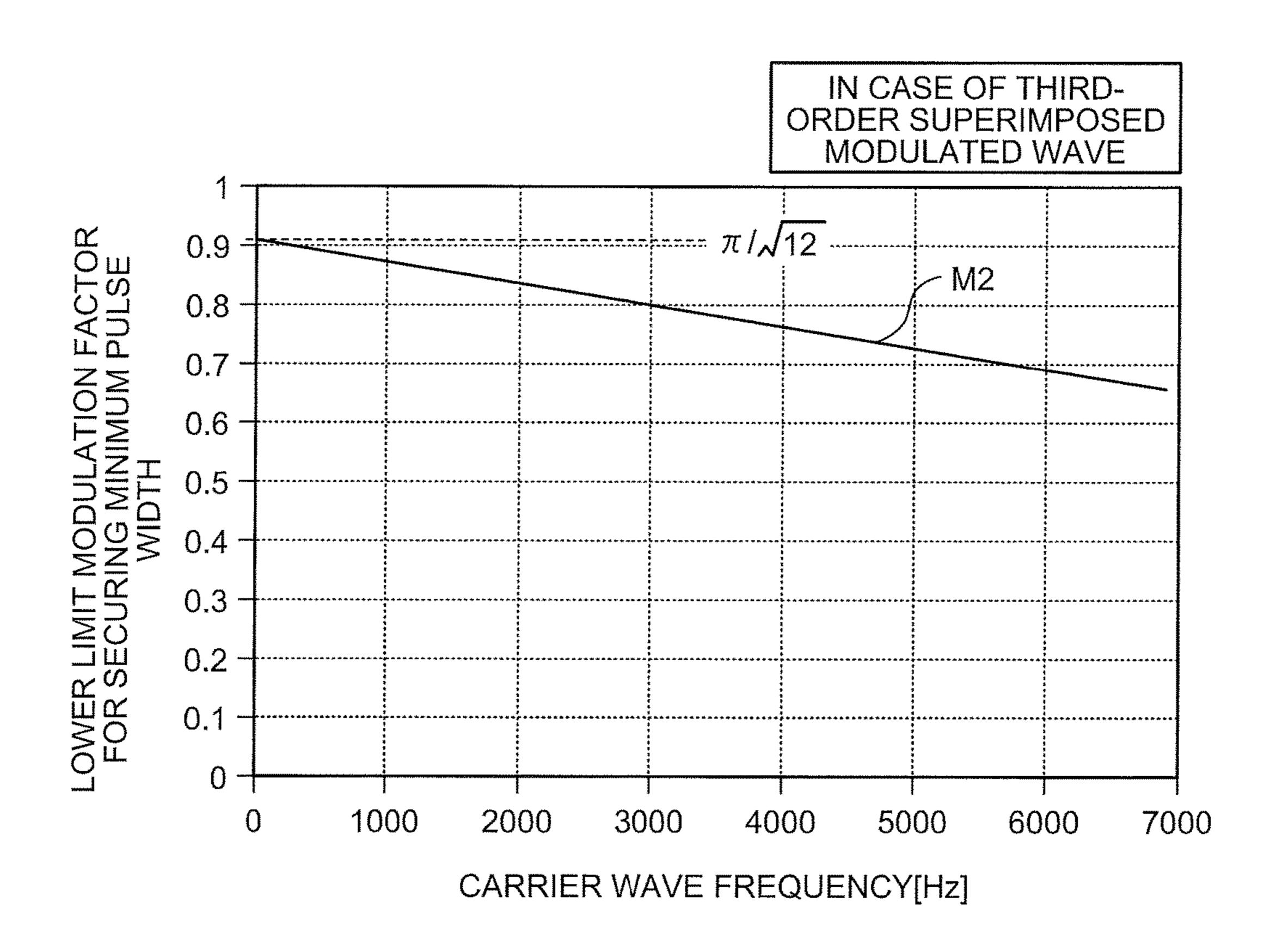
LOWER LIMIT MODULATION FACTOR=( $\pi/\sqrt{12}$ ) ×(1-MINIMUM PULSE WIDTH×CARRIER WAVE FREQUENCY×2)
