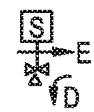
SOLENOID OPERATED 3-WAY VALVE PRESSURE ON ENERGIZE VENT ON DE-ENERGIZE
