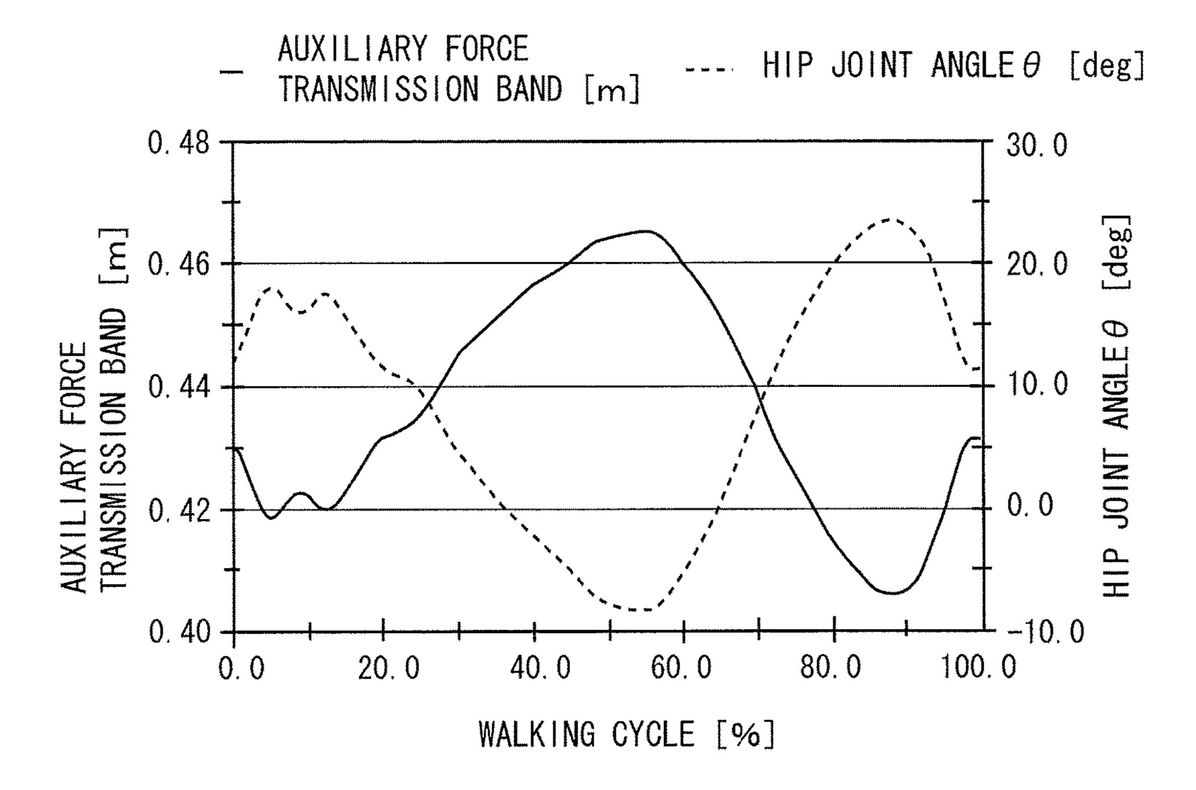
CALCULATION OF LENGTH OF AUXILIARY FORCE TRANSMISSION BAND (AC)
