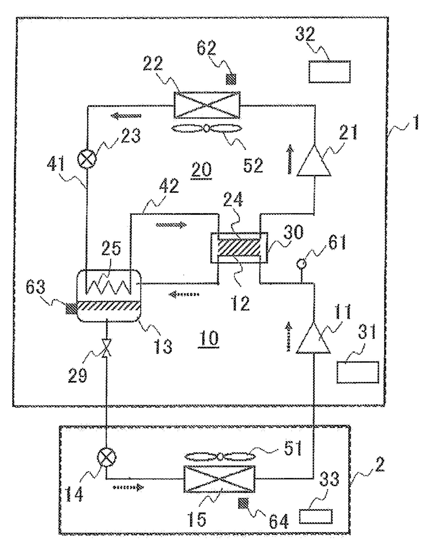
REFRIGERANT FLOW IN HIGH-STAGE REFRIGERATION CYCLE
