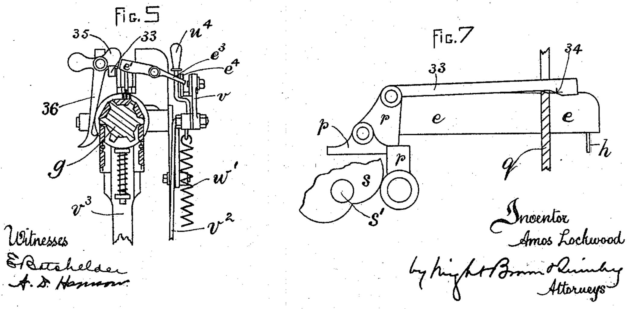
SHUTTLE BOX OPERATING MECHANISM FOR LOOMS.
