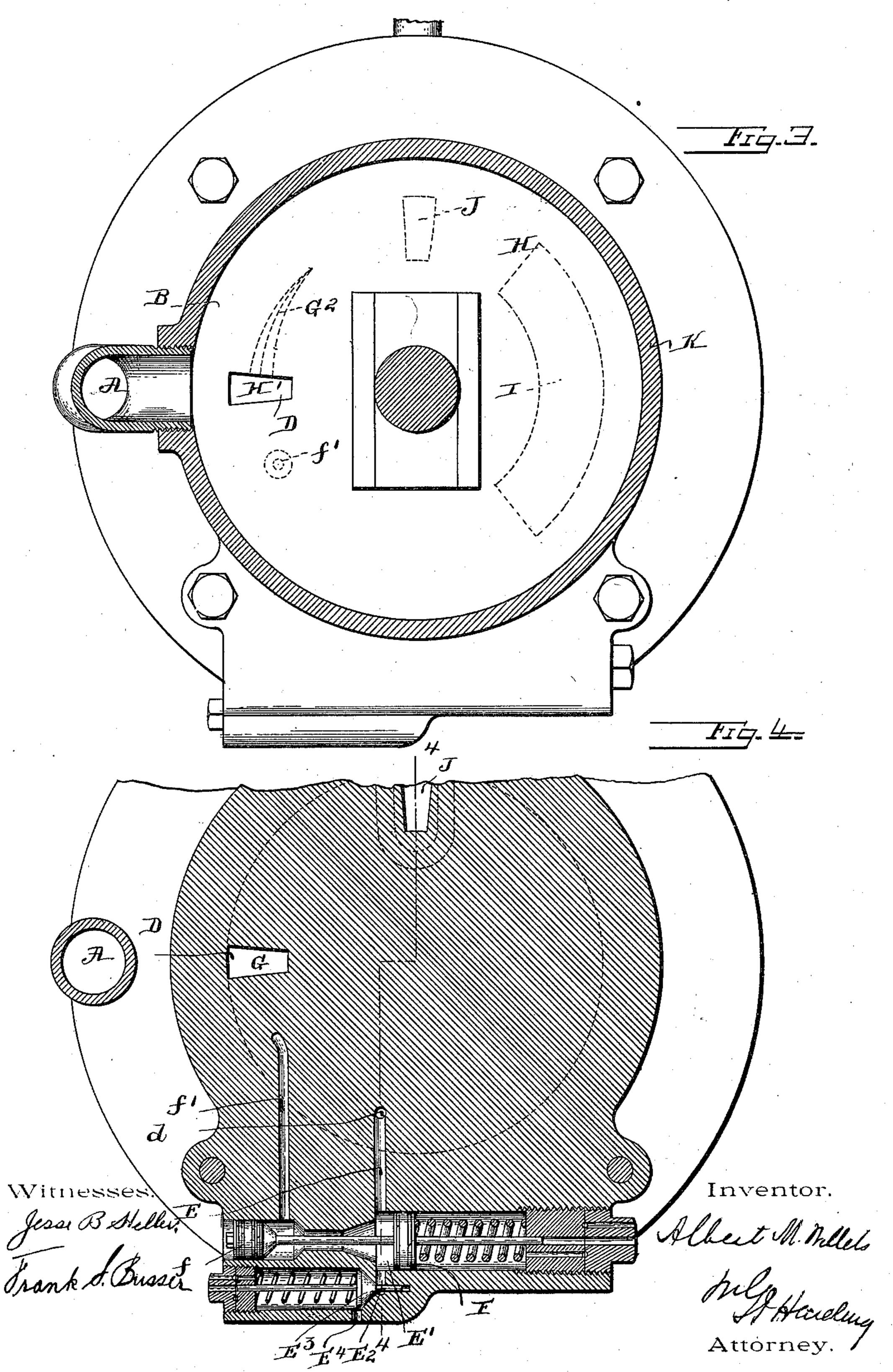
ENGINEER'S VALVE FOR AIR BRAKE SYSTEMS.
