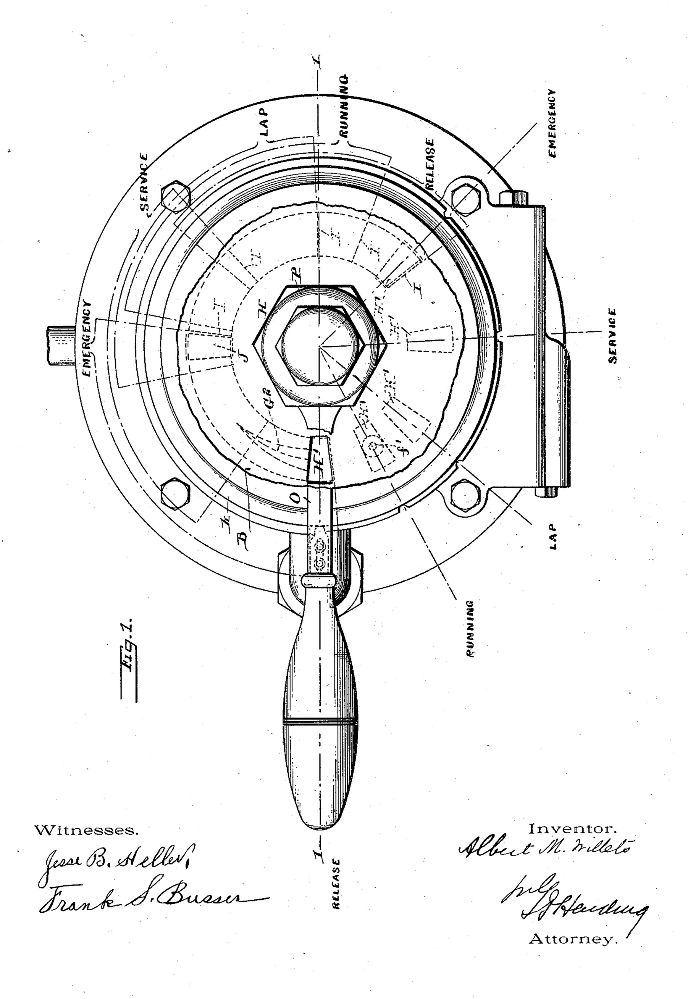
ENGINEER'S VALVE FOR AIR BRAKE SYSTEMS.
