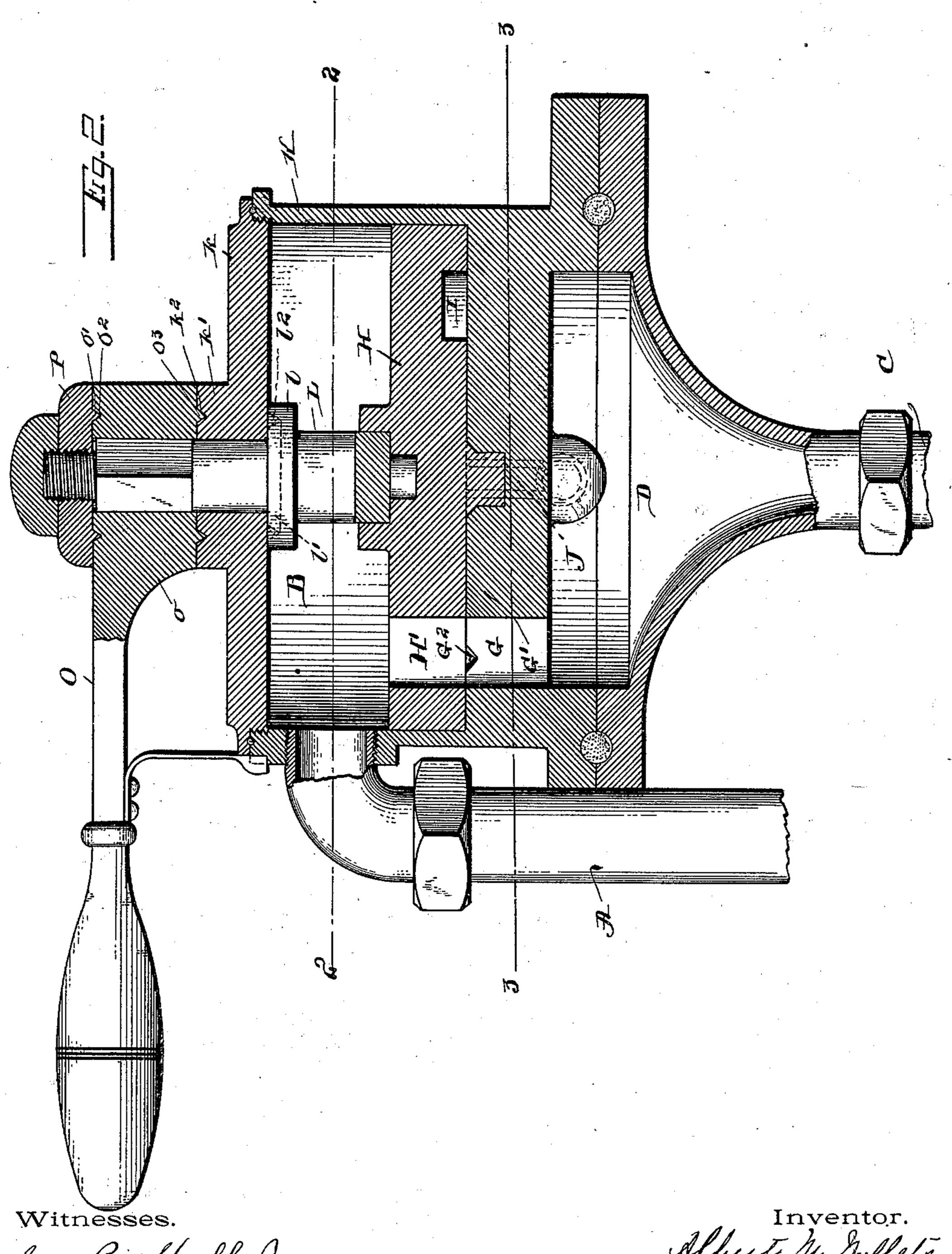
ENGINEER'S VALVE FOR AIR BRAKE SYSTEMS.
