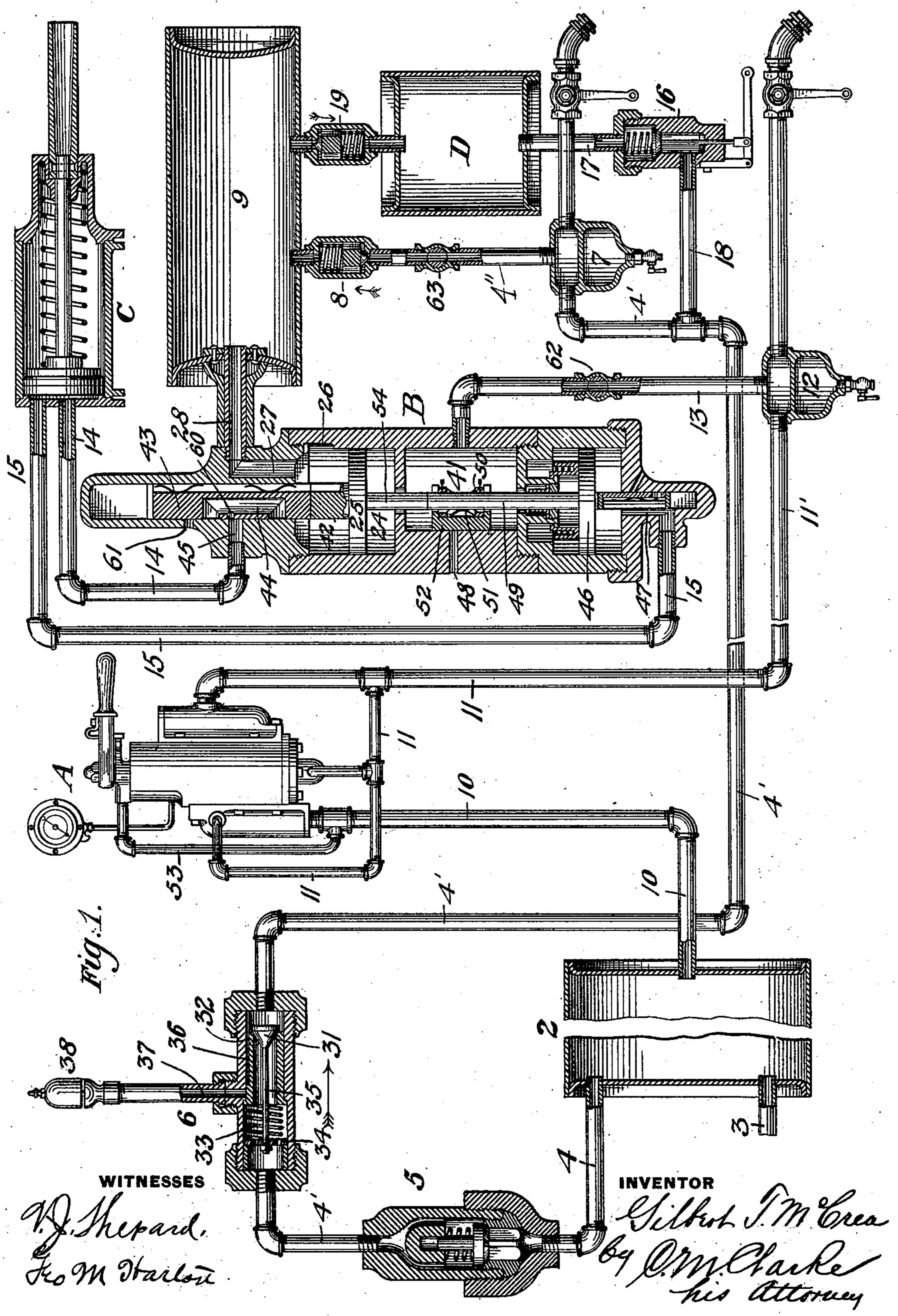
FLUID PRESSURE AUTOMATIC BRAKE MECHANISM.
