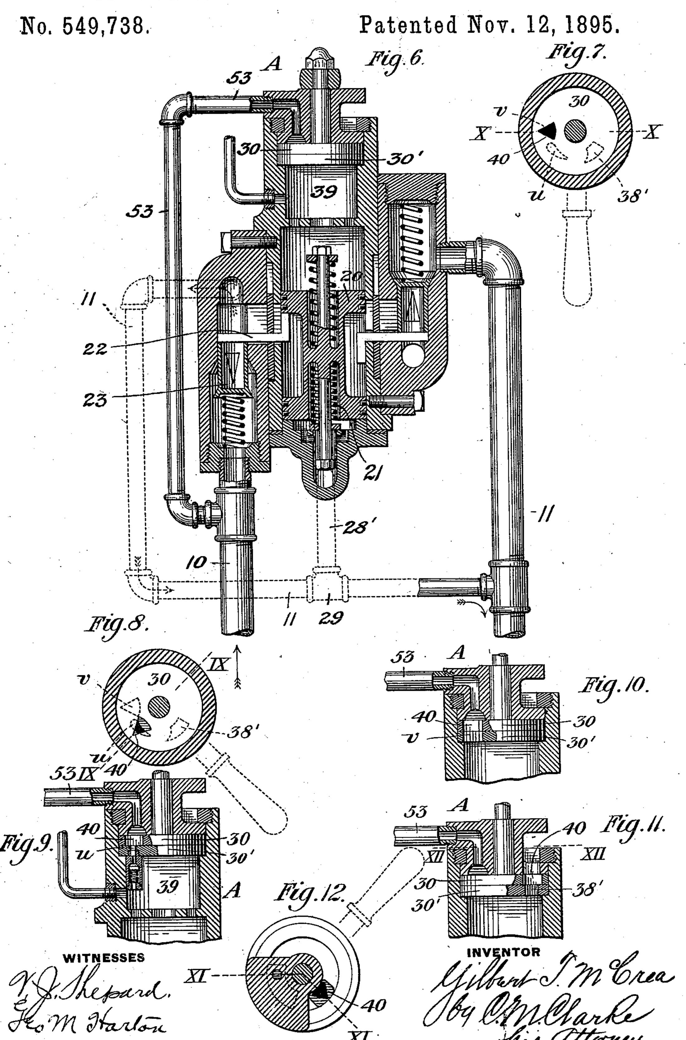
FLUID PRESSURE AUTOMATIC BRAKE MECHANISM.
