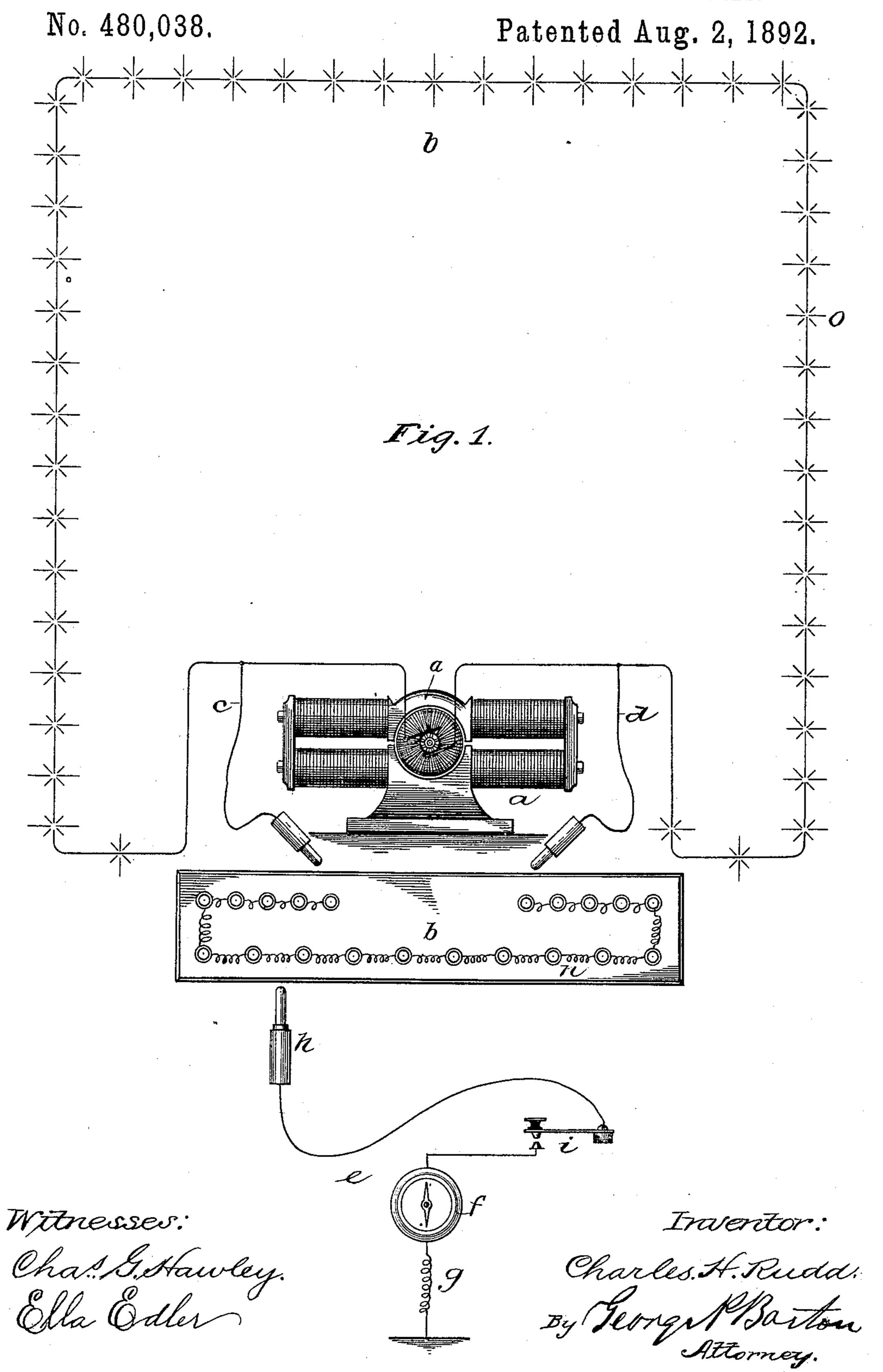
TESTING APPARATUS FOR ELECTRIC LIGHTING CIRCUITS.
