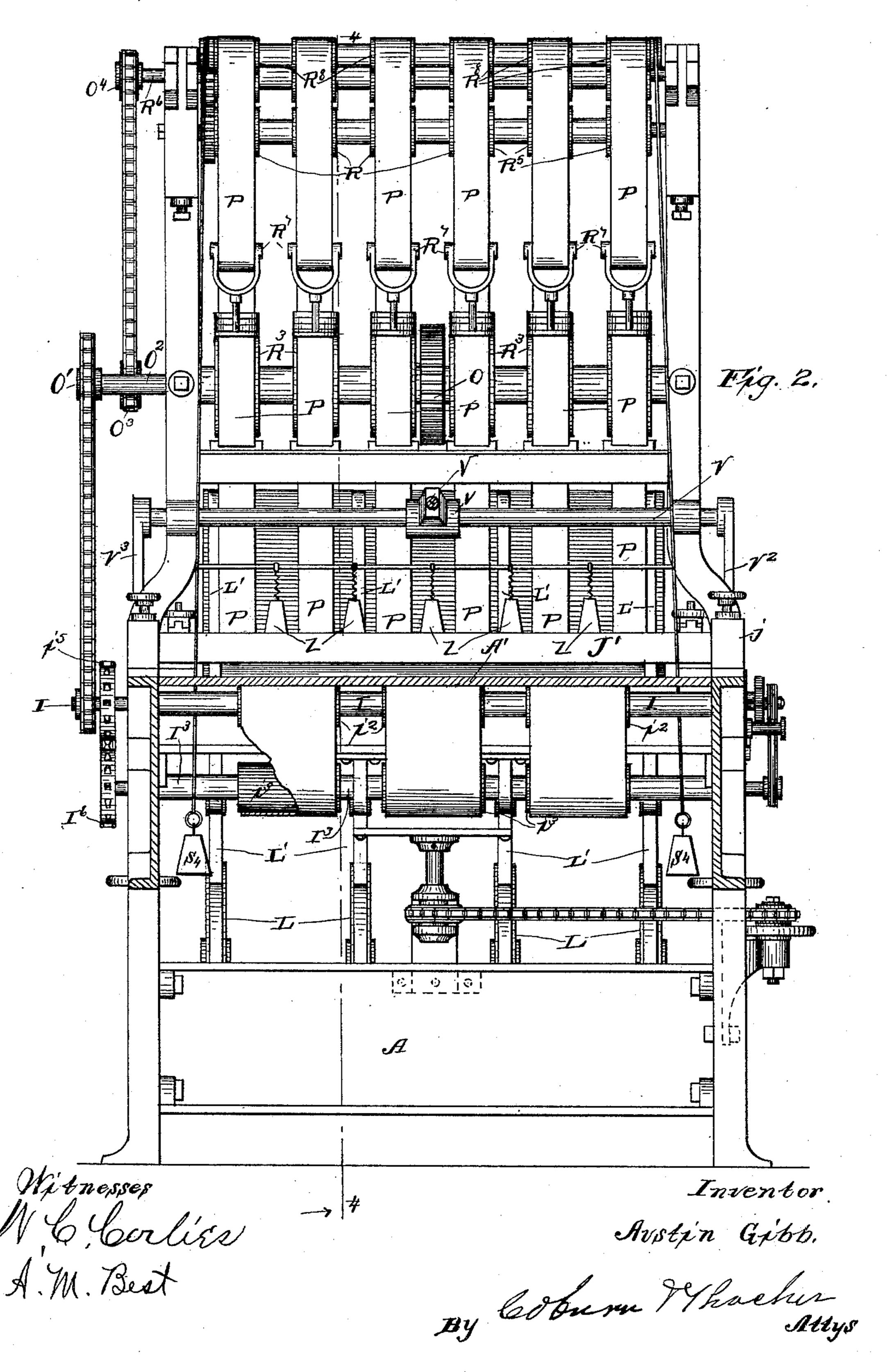
MACHINE FOR MAKING BOX PLAITED PAPER FOR CARPET LININGS, &c.
