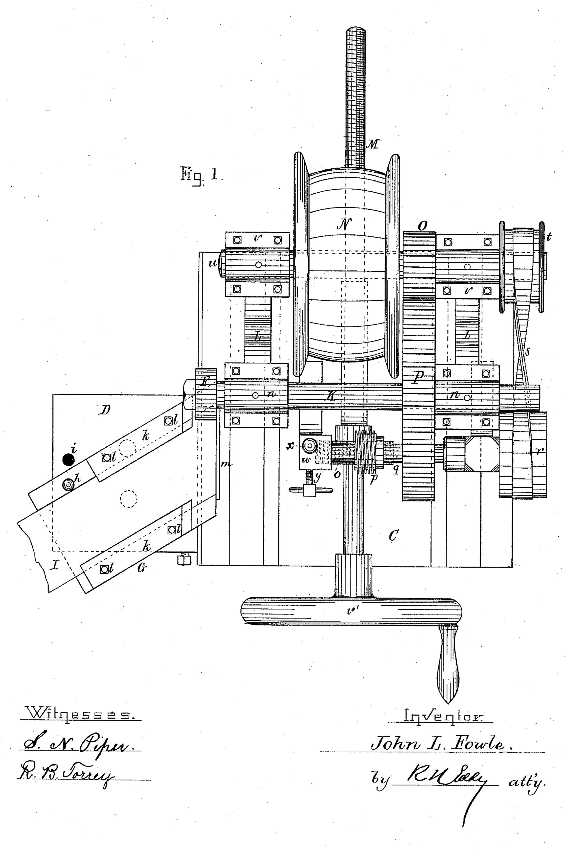
MACHINE FOR MILLING THE ENDS OF BAND SAWS.
