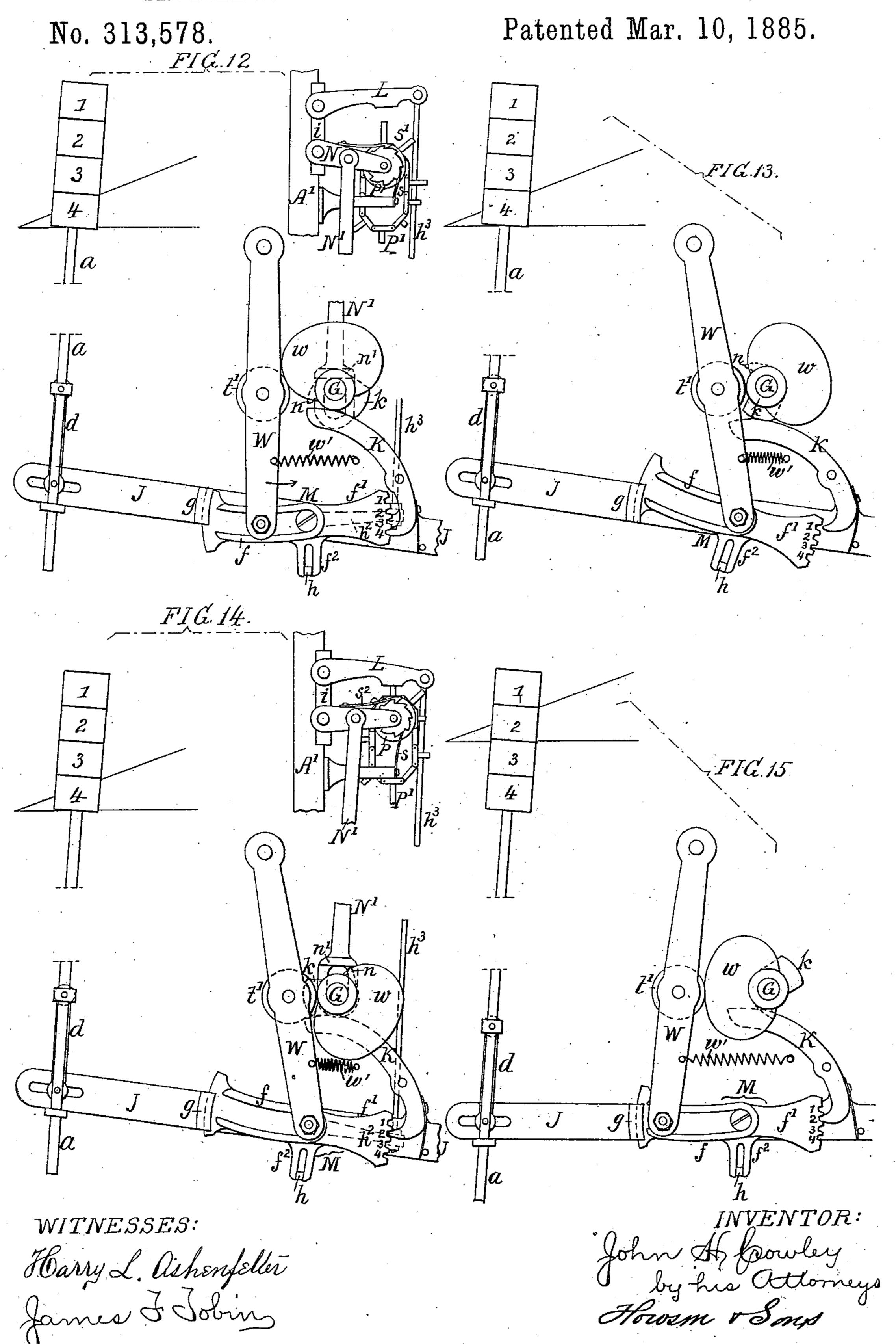
SHUTTLE BOX OPERATING MECHANISM FOR LOOMS.
